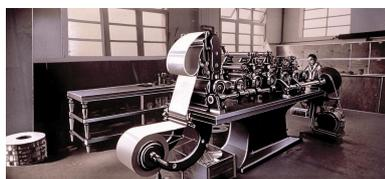
Photographie retouchée d'une machine à imprimer les boîtes de vrac de 125 grs.
