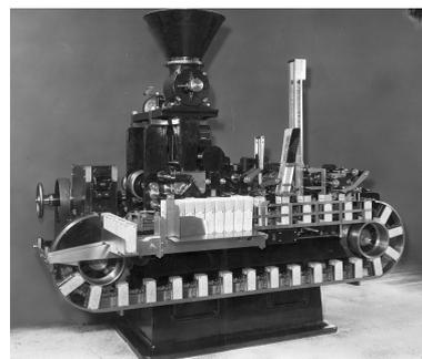
Machine Chambon installée au 2e étage du bâtiment principal, servant au conditionnement des boîtes de tisanes en vrac. En activité, elle était placée sous le grand entonnoir et était reliée par une chaîne à la machine fabriquant les boîtes.
