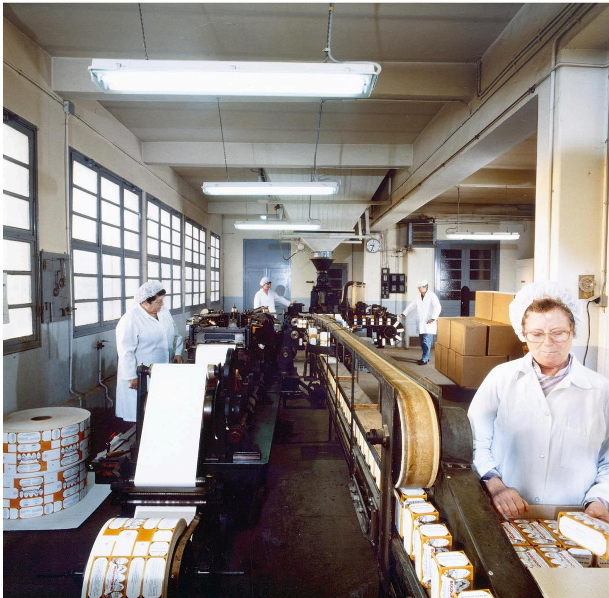
La chaîne de conditionnement du 2e étage du bâtiment principal en activité. A gauche, la machine fabriquant des boîtes pour le vrac (à partir de papier cartonné imprimé et de papier fin formant le sac intérieur). Les boîtes étaient ensuite remplies de tisane à l'aide de la machine au fond (sous le grand entonnoir) et revenaient sur un tapis roulant (le temps que la colle sèche) pour être stockées dans des cartons d'expédition.
