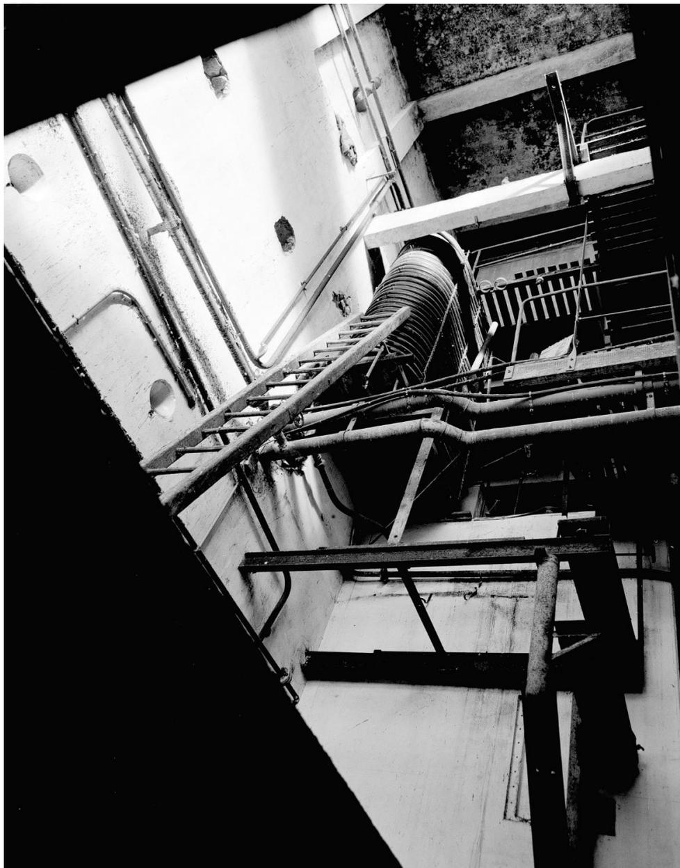
Dans le bâtiment D, installation d'extraction d'alcaloïdes végétaux pharmaceutiques, datant des années 20. On distingue un serpentin de refroidissement.
