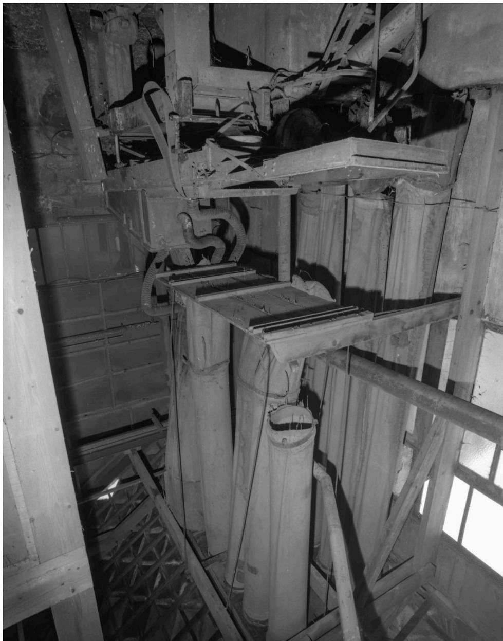
Bâtiment L, tamis et filtres à poussières, en sortie d'un broyeur de plantes. Lorsque les plantes sortaient du broyeur, elles étaient soufflées vers le haut puis cheminaient horizontalement ; les particules lourdes retombaient les premières, les poussières retombant dans les derniers conduits. Au bas des conduits, un système de grilles vibrant tamisait les produits filtrés.
