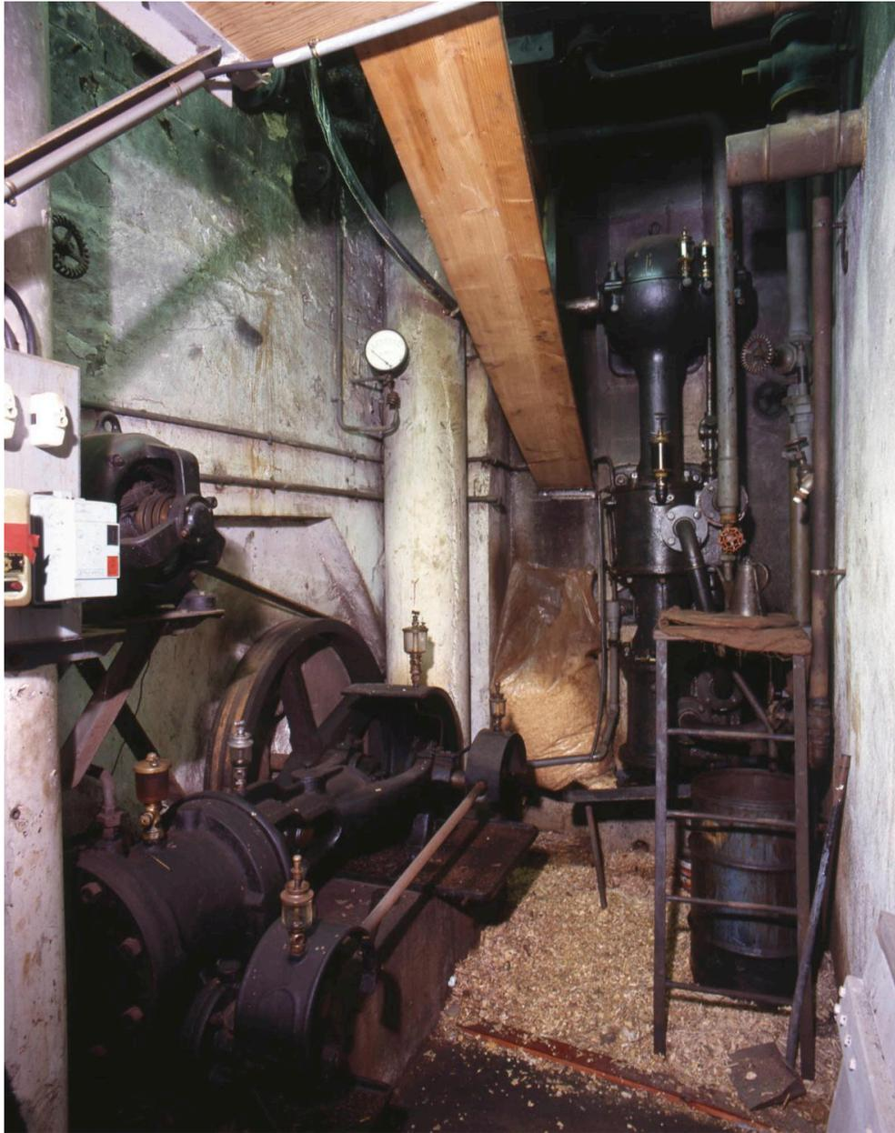
Bâtiment A (à l'angle des bâtiment G et H). A gauche, un compresseur et au fond, une pompe à vide, utilisés pour l'extraction végétale. Le vide permettait d'évaporer les solvants sans chauffer beaucoup, protégeant ainsi les principes actifs des plantes.
