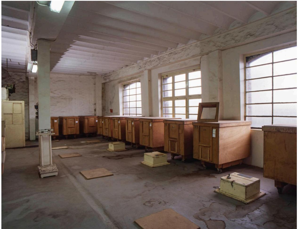
2e étage du bâtiment principal. Alignement de wagonnets en bois servant au transport des plantes, posé sur l'un d'eux un filtre. Les trappes au sol permettaient d'alimenter des machines à conditionner, installées à l'étage du dessous.
