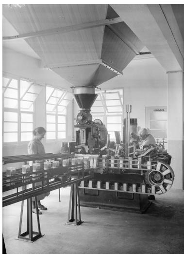
Machine remplissant les boîtes de tisane en vrac en fonctionnement.
