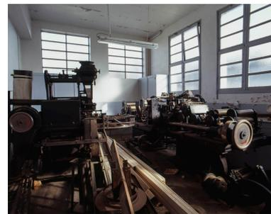
2e étage du bâtiment principal. Machine Chambon, à l'origine servant à fabriquer des boîtes de sucre en poudre, réadaptée pour confectionner des boîtes de tisane en vrac. Elle fabriquait des boîtes cartonnées garnies d'un sachet intérieur en papier (pour éviter les fuites de matière première aux angles). machine hors service après la tempête de 1999.
