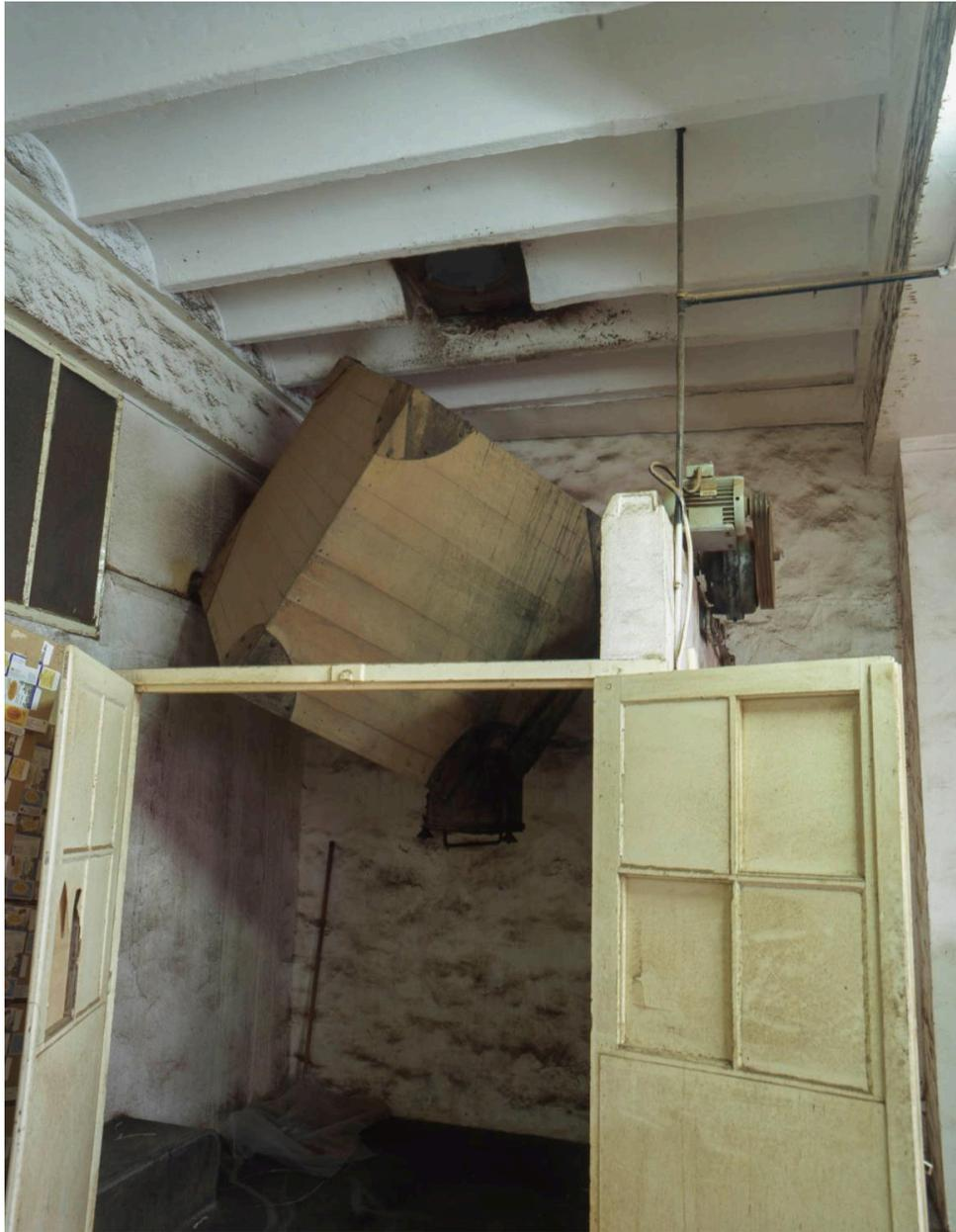
2e étage du bâtiment principal, le second mélangeur cubique en bois, réinstallé ici pour dépannage ou traitement de petits lots, après l'installation du grand mélangeur en acier, au 4e étage. Une trappe permet son alimentation par le niveau supérieur.
