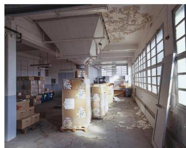
2e étage du bâtiment principal. Entonnoir d'où arrivait le mélange de plantes du grand mélangeur en acier, placé au 4e étage. La principale machine à conditionner était placée en dessous. Ici, après l'arrêt de la production, l'espace sert de stockage.
