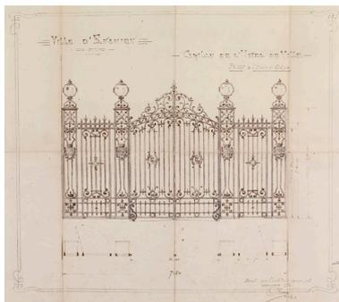
Dessin des grilles d'entrée du jardin de la mairie, 1912. Elévation et plan. Elle est composée d'une porte charretière et de deux guichets. (AM Enghien-les-Bains, M2)
