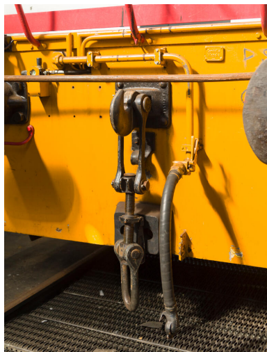
Local des locotracteurs. Locaux des locotracteurs. Dispositifs d'accrochage des wagons par manilles (Flex). Phot. Stéphane Asseline, Phot. Stéphane Asseline IVR11_20237700400NUC4A
