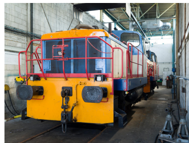
Local des locotracteurs. Locotracteur 11-46, utilisé pour assurer le mouvement des wagons jusqu'aux postes de chargement. Exploité depuis l'origine du site. Phot. Stéphane Asseline, Phot. Stéphane Asseline IVR11_20237700393NUC4A
