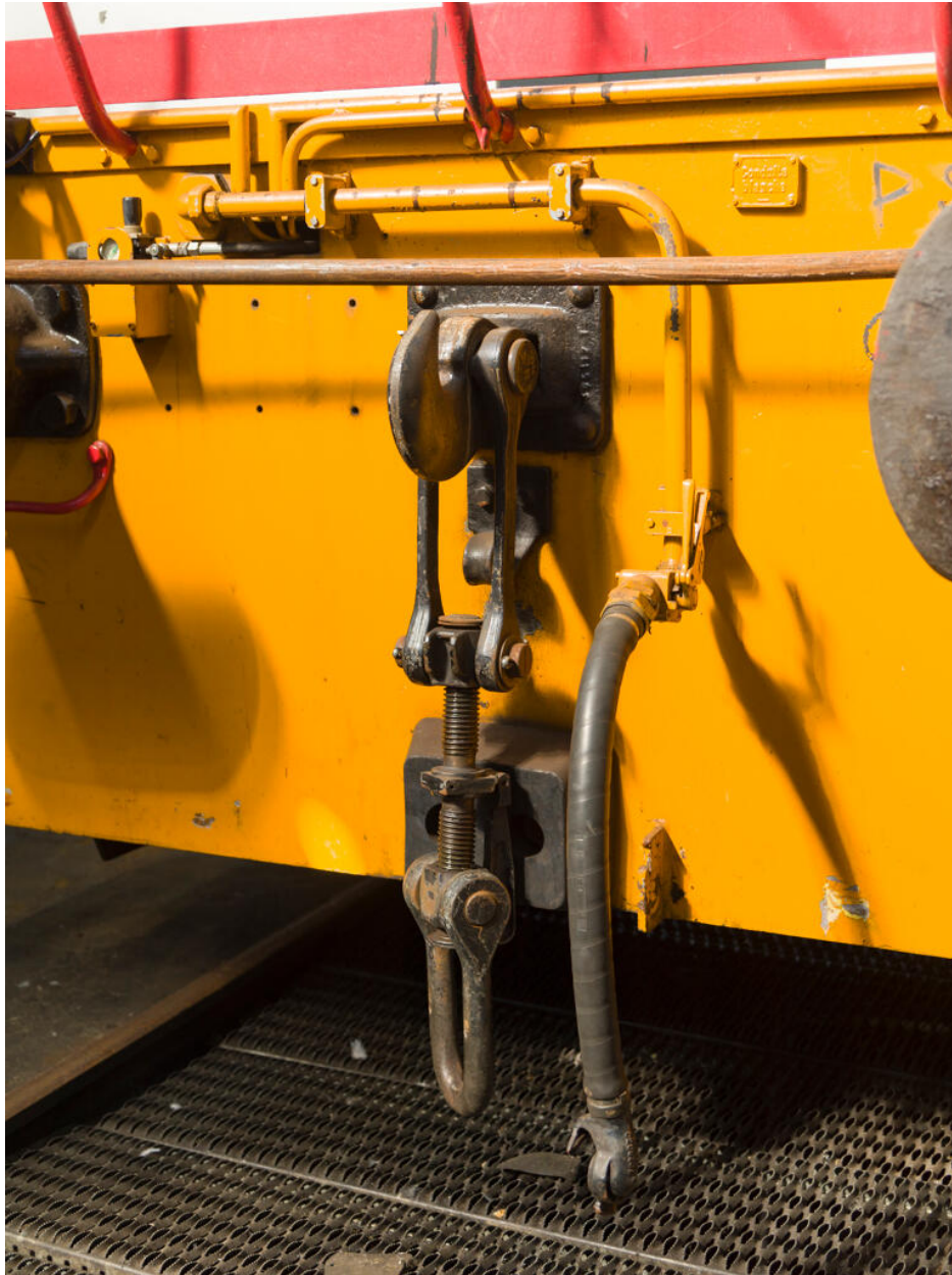
Local des locotracteurs. Locaux des locotracteurs. Dispositifs d'accrochage des wagons par manilles (Flex).
