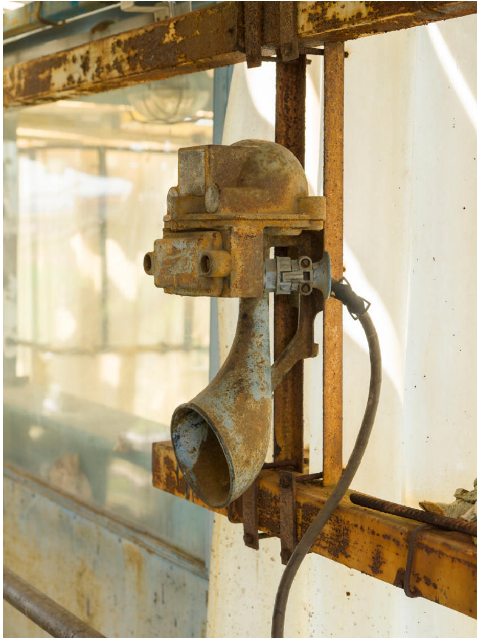
Chargement poste fer (Unité 540). Ancien avertisseur sonore : il s'agit d'avertir d'un treuillage des wagons en cours.
