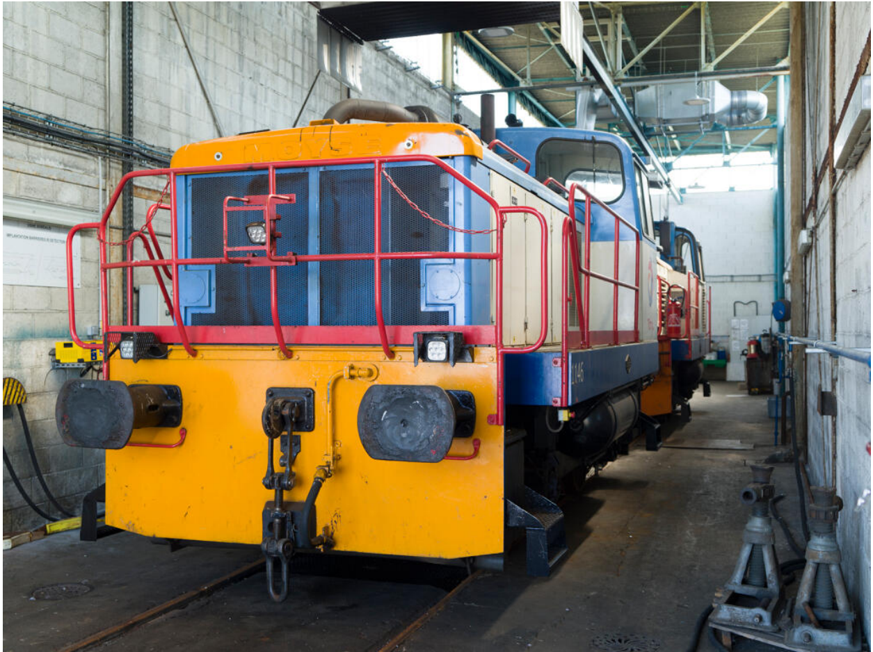
Local des locotracteurs. Locotracteur 11-46, utilisé pour assurer le mouvement des wagons jusqu'aux postes de chargement. Exploité depuis l'origine du site.
