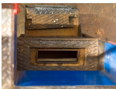
Local des locotracteurs. Remplissage des sablières du locotracteur 11-46 (dispositif anti-patinage). Phot. Stéphane Asseline, Phot. Stéphane Asseline IVR11_20237700395NUC4A
