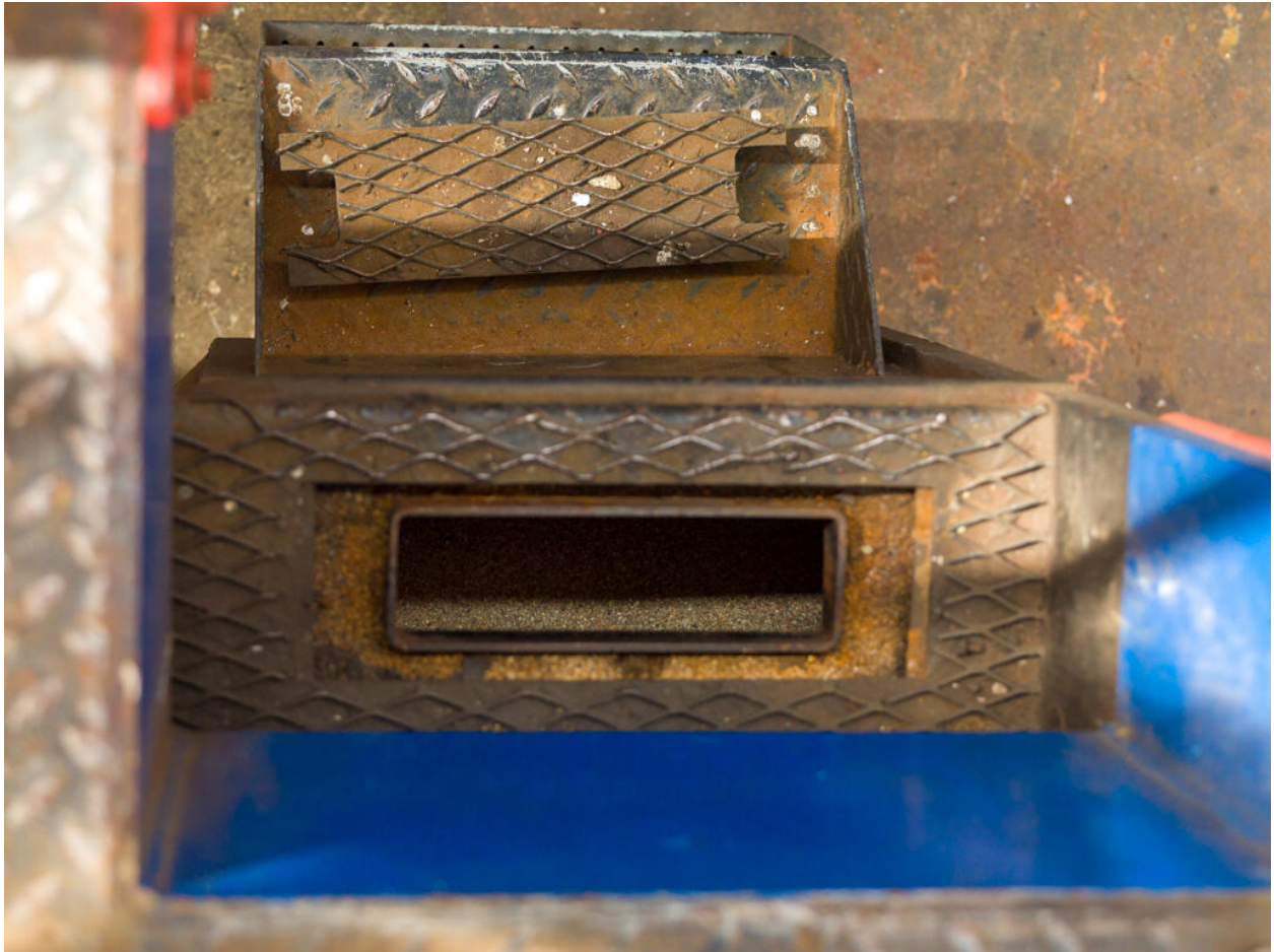
Local des locotracteurs. Remplissage des sablières du locotracteur 11-46 (dispositif anti-patinage).
