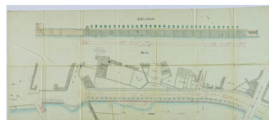
Projet d'un quai sur la rive droite de la Marne, entre la rue du Grand-Cerf et la place Lafayette. Avec plan au sol (en bas) et élévation du quai (en haut). Dressé par l'architecte de la ville le 15 décembre 1880. Calque aquarellé. (AD Seine-et-Marne. 4 Op 284/14) Phot. Yvan (reproduction) Bourhis IVR11_20137700033NUC4A
