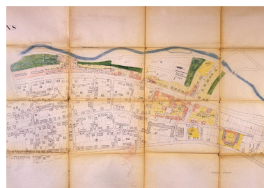
Estimation du remblaiement dans le quartier du Val, s. d. En rouge, les remblaiements déjà existants ; en jaune clair, remblaiement partiel des surfaces remembrées (60 000 m 3 , 28 millions) ; en vert et jaune vif, remblaiement total des surfaces remembrées (80 000 m 3 , 40 millions). IVR11_20039100027XA
