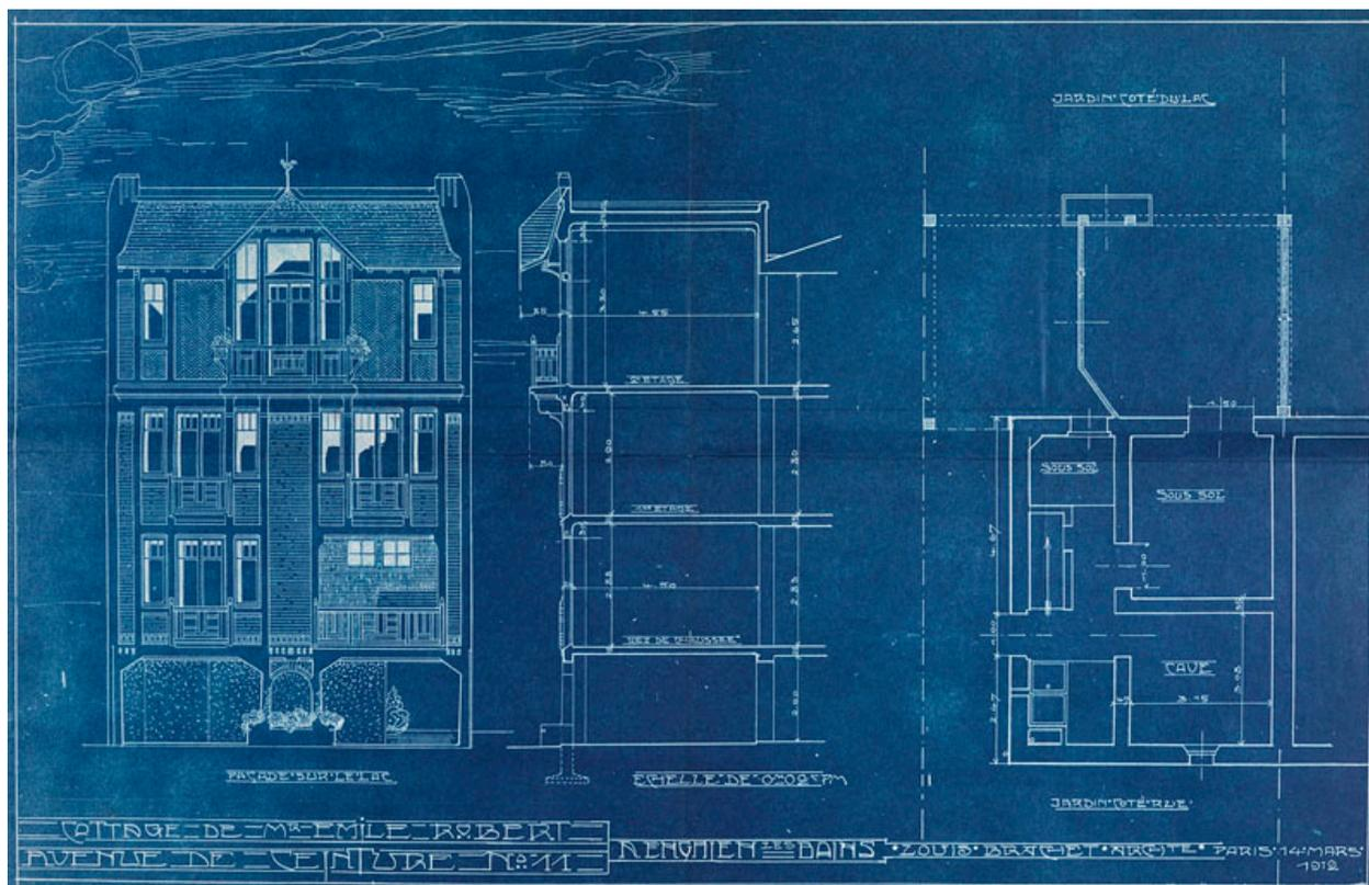
Elévation, plan et coupe de l'édifice, 1912. (AM Enghien-les-Bains, 1T 29, autorisations de permis de construire)
