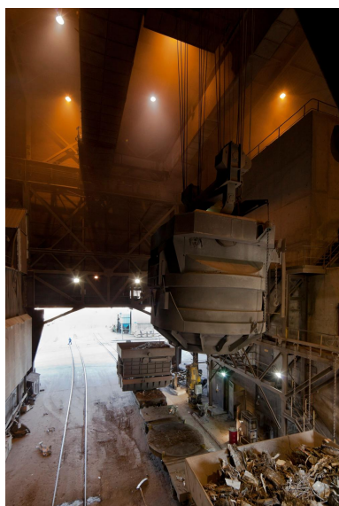
Halle du four, transbordement du panier vers le four. (réf. Département Seine-et-Marne : IVD77_2013_77_00272_NUCA) Phot. Yvan Bourhis IVR11_20197700534NUC4A
