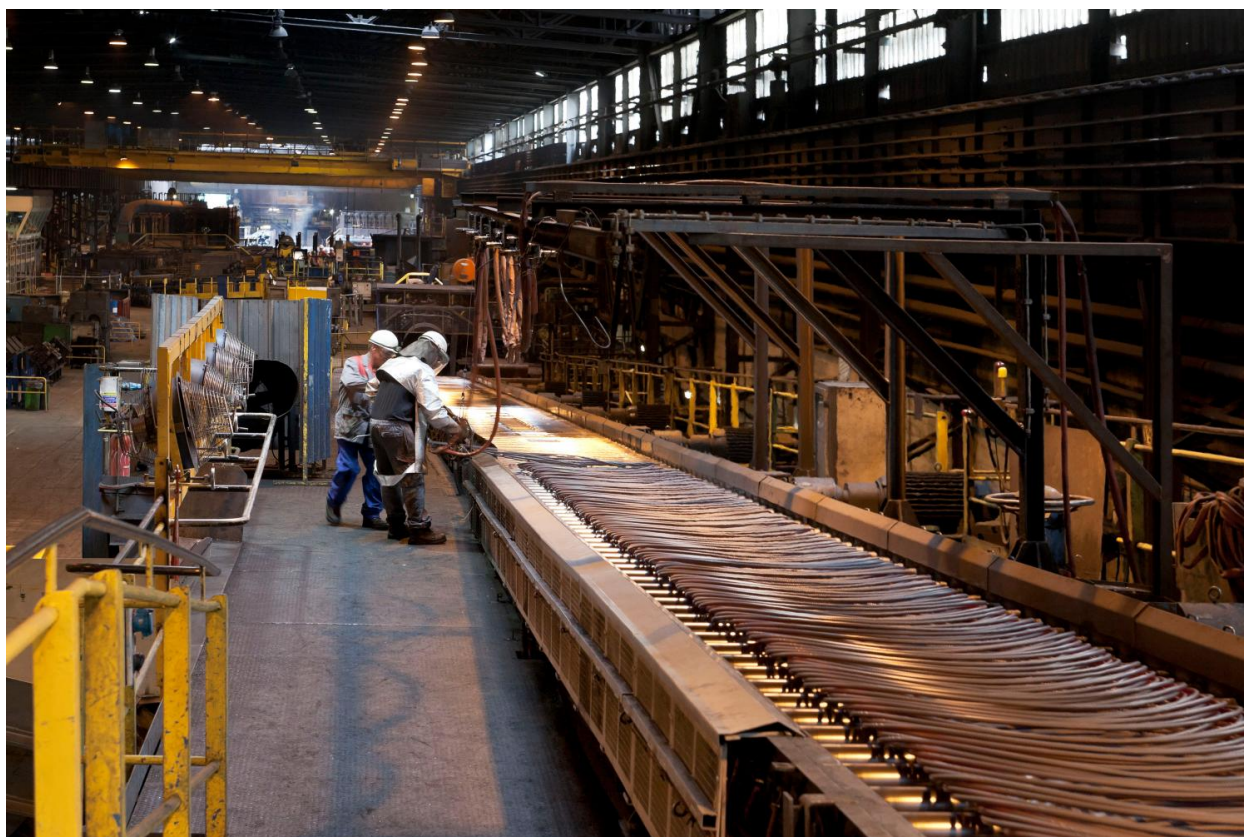
Halle des laminoirs, ouvriers au travail au train de laminage, formation des spires. (réf. Département Seine-et-Marne : IVD77_2013_77_00254_NUCA)
