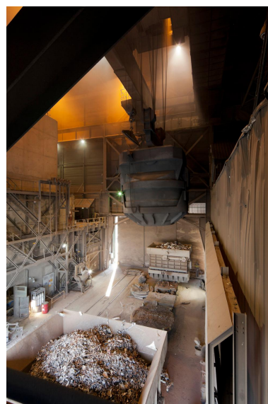
Halle du four, déplacement du panier. (réf. Département Seine-et-Marne : IVD77_2013_77_00271_NUCA) Phot. Yvan Bourhis IVR11_20197700532NUC4A
