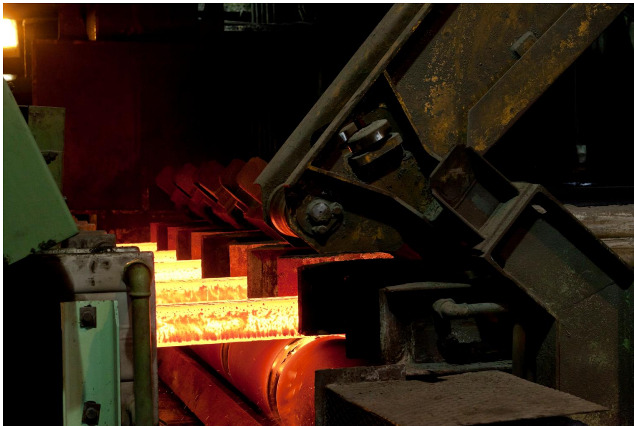
Halle à billettes, formation des billettes. (réf. Département Seine-et-Marne : IVD77_2013_77_00247_NUCA)
