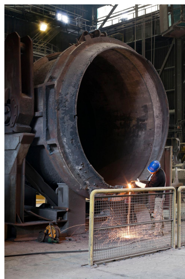
Entretien des poches, ouvrier au travail. (réf. Département de Seine-et-Marne : IVD77_2013_77_00262_NUCA) Phot. Yvan Bourhis IVR11_20197700429NUC4A
