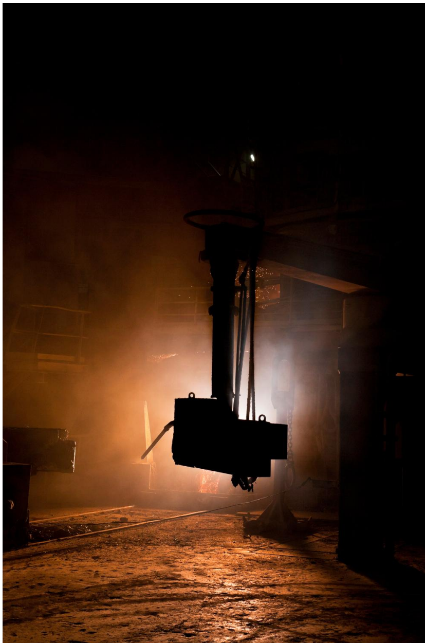
Chariot transportant la poche de coulée de la halle de fusion à la halle de coulée. (réf. Département Seine-et-Marne : IVD77_2013_77_00240_NUCA)
