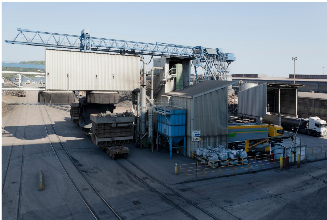
Parc à ferrailles, chargement du panier. (réf Département Seine-et-Marne : IVD77_2013_77_00270_NUCA)
