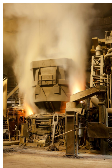
Halle du four, fusion des ferrailles. (réf. Département Seine-et-Marne : IVD77_2013_77_00275_NUCA) Phot. Yvan Bourhis IVR11_20197700537NUC4A
