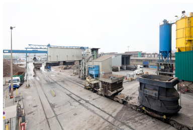
Parc à ferrailles avec un wagonnet chargé en ferrailles destiné à l'alimentation du four. (réf. Département Seine-et-Marne : IVD77_2013_77_00236_NUCA) Phot. Yvan Bourhis IVR11_20197700413NUC4A
