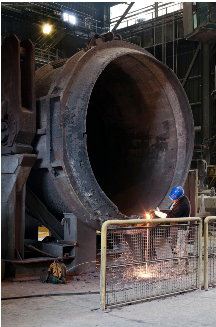
Entretien des poches, ouvrier au travail. (réf. Département de Seine-et-Marne : IVD77_2013_77_00262_NUCA)
