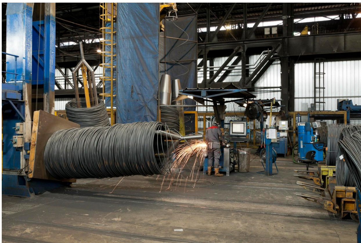
Trancanage des bobines. (réf. Département Seine-et-Marne : IVD77_2013_77_00277_NUCA)
