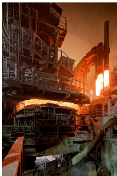
Halle du four, four électrique avec les trois électrodes en graphite permettant d'obtenir la fusion. (réf. Département Seine-et-Marne : IVD77_2013_77_00242_NUCA) Phot. Yvan Bourhis IVR11_20197700420NUC4A
