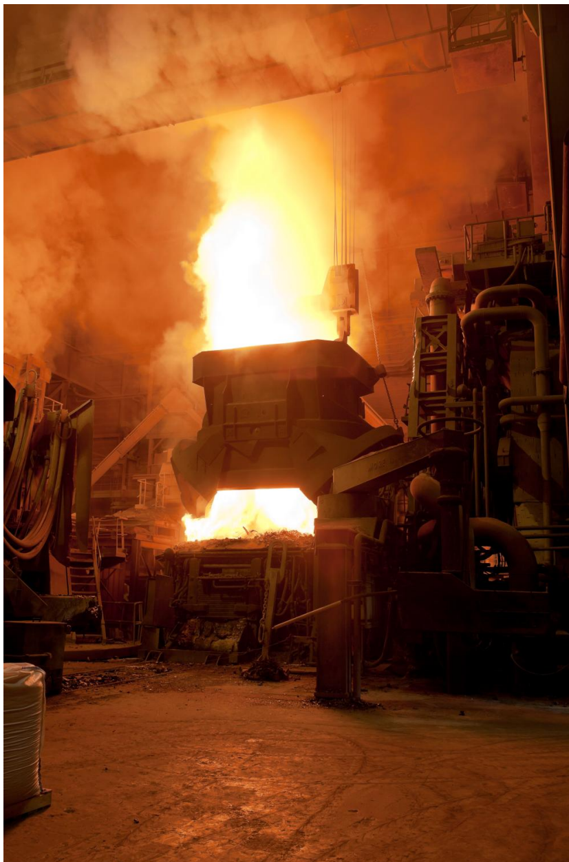
Halle du four, fusion des ferrailles. (réf. Département Seine-et-Marne : IVD77_2013_77_00274_NUCA)
