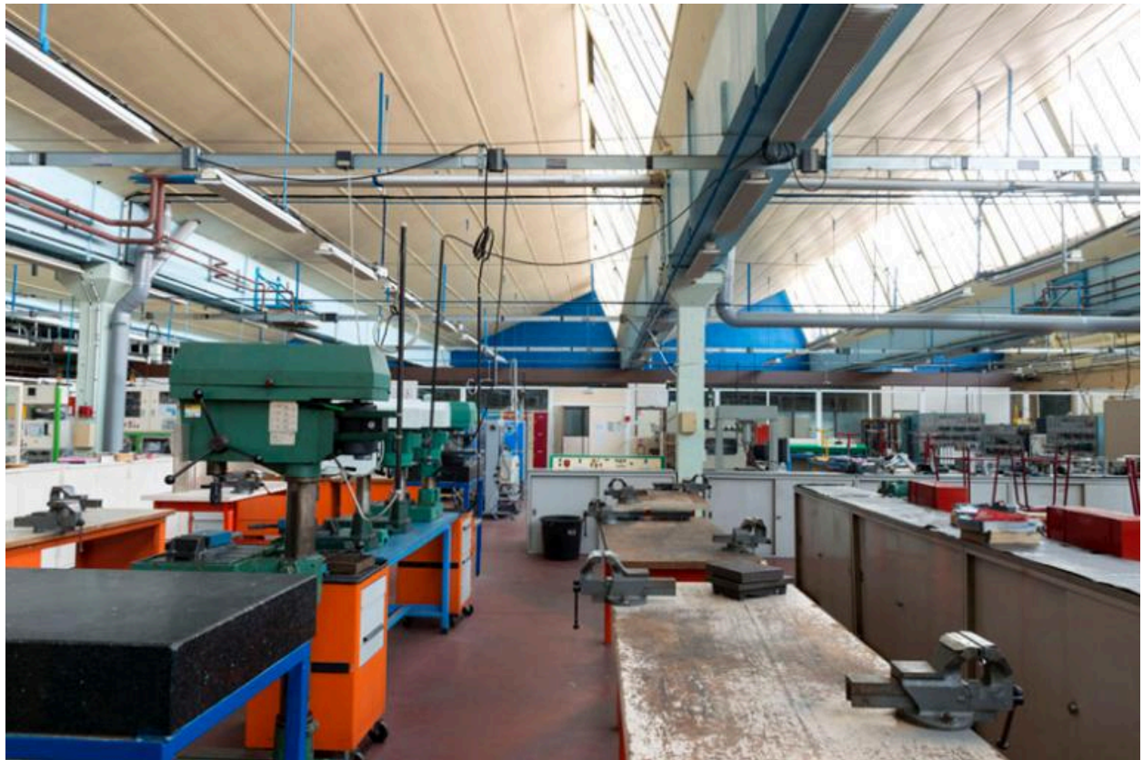
Lycée Rostand : l'atelier de la section Maintenance des Equipements Electriques et Pilote de Ligne de Production. On comprend ici l'efficacité de l'éclairage naturel par les sheds.
