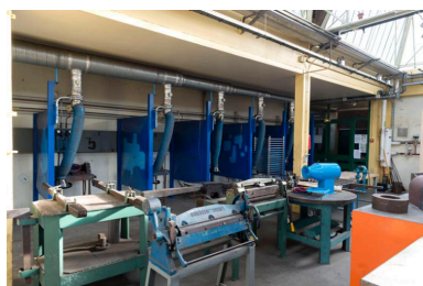
Lycée Rostand : l'atelier de la section Réalisations industrielles en Chaudronnerie et Soudures (RICS). Le système d'aspiration. Phot. Laurent Kruszyk IVR11_20177800305NUC4A
