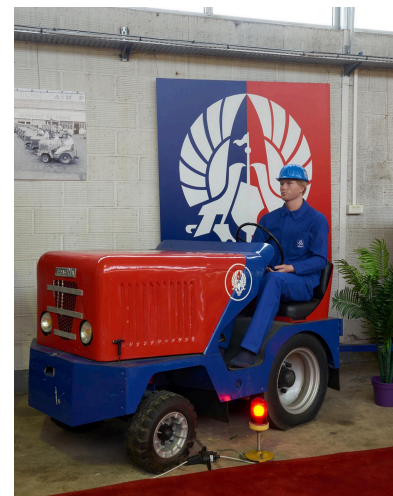
Tracteur de piste "TRACMA, type TE 75, (année de sortie: 1955, moteur Peugeot type 403 Berline, 3 vitesses + marche arrière, poids total: 1100kg, effort de traction: 750 daN, charge tractée: 10/15 tonnes). Ce TRACMA a été restauré en 1991 par le Groupe ADP avec l'aide des sociétés AEROSTOCK et TRACMA. mission Gestion du patrimoine historique du Groupe ADP, Hall 2, bâtiment 615. Autr. TRACMA IVR11_20209400422NUC4A
