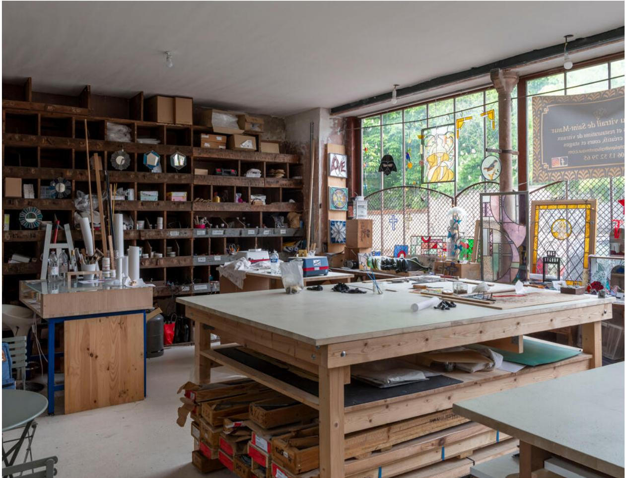
Atelier au Vitrail de Saint-Maur-des-Fossés. Au premier plan, les deux établis, avec les caisses de plomb entreposées en dessous. Au fond à gauche, la « table lumineuse » (poste de peinture).
