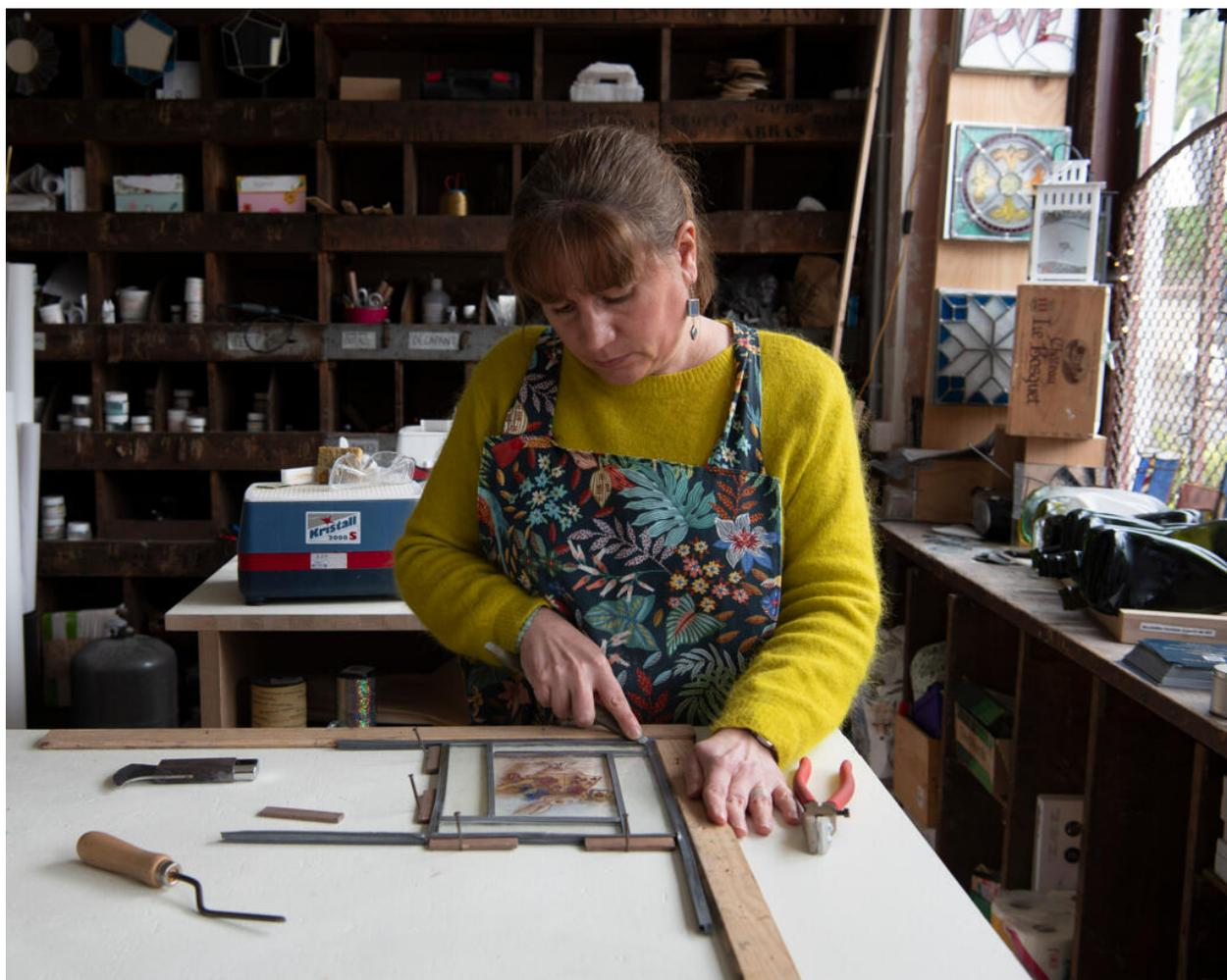
Atelier au Vitrail de Saint-Maur-des-Fossés. Les plombs sont refermés, avant la soudure. Pour faire le montage, chaque plomb est ouvert avec l'ouvre-plomb, qui est passé dans les profilés de plomb pour y mettre le vitrail. Après l'installation du verre, les plombs sont refermés.
