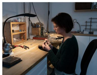
Atelier de bijouterie Siana Swieca Bijoux. Anaïs Swieca émerise l'intérieur du corps d'une bague avec sa pièce à main. Du papier à grains variés est utilisé pour créer des rayures les plus fines possibles, afin qu'elles soient invisibles. Cette étape précède le polissage.
