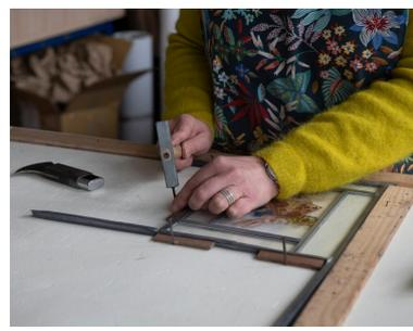
Atelier au Vitrail de Saint-Maur-des-Fossés. Sertissage au plomb, avec marteau et clou. À gauche, le couteau à plomb.
