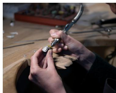
Atelier de bijouterie Siana Swieca Bijoux. Anaïs Swieca émerise l'intérieur du corps d'une bague avec sa pièce à main. Du papier à grains variés est utilisé pour créer des rayures les plus fines possibles, afin qu'elles soient invisibles. Cette étape précède le polissage.
