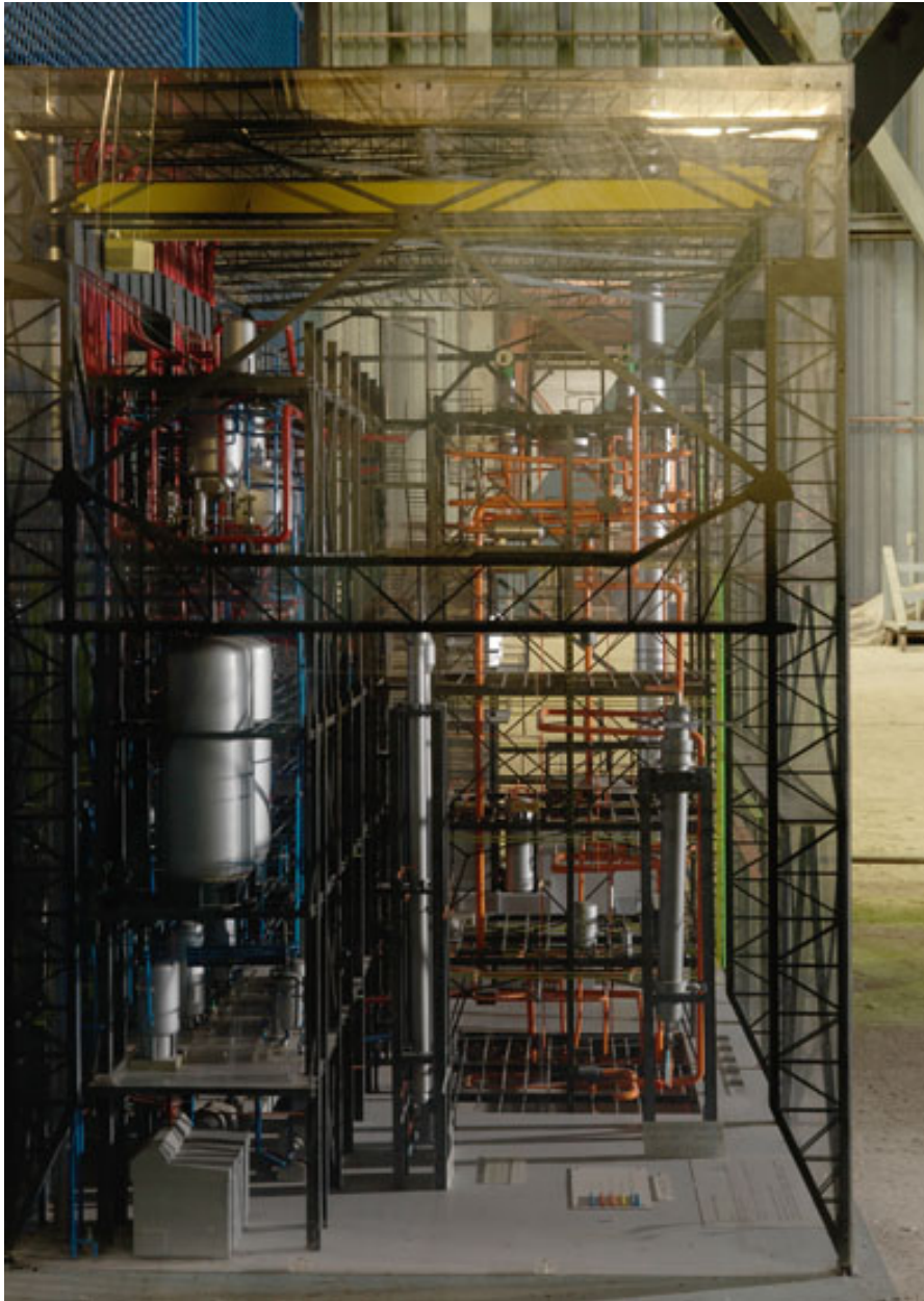
Maquette du hall CGVS (Circuit d'essais de Générateurs de Vapeur chauffés au Sodium).
