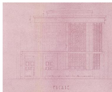
Projet de Claude Le Coeur en 1948 : étude pour la façade principale, 3 mai 1948. Les murs sont prévus en maçonnerie de briques creuses sous enduit, la couverture en aluminium posée sur voligeage.
