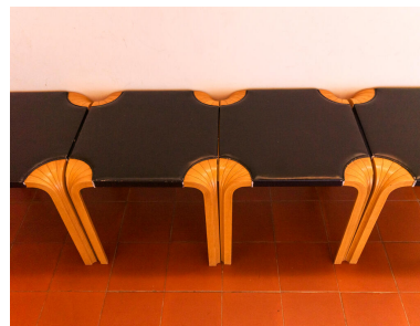
Tabourets modulables à pieds en éventail formés de cinq éléments en bois thermomoulés, assemblés et collés. Fabriqués par Artek sur le dessin d'Aalto pour la maison Carré. Phot. Asseline Stéphane IVR11_20247800350NUC4A
