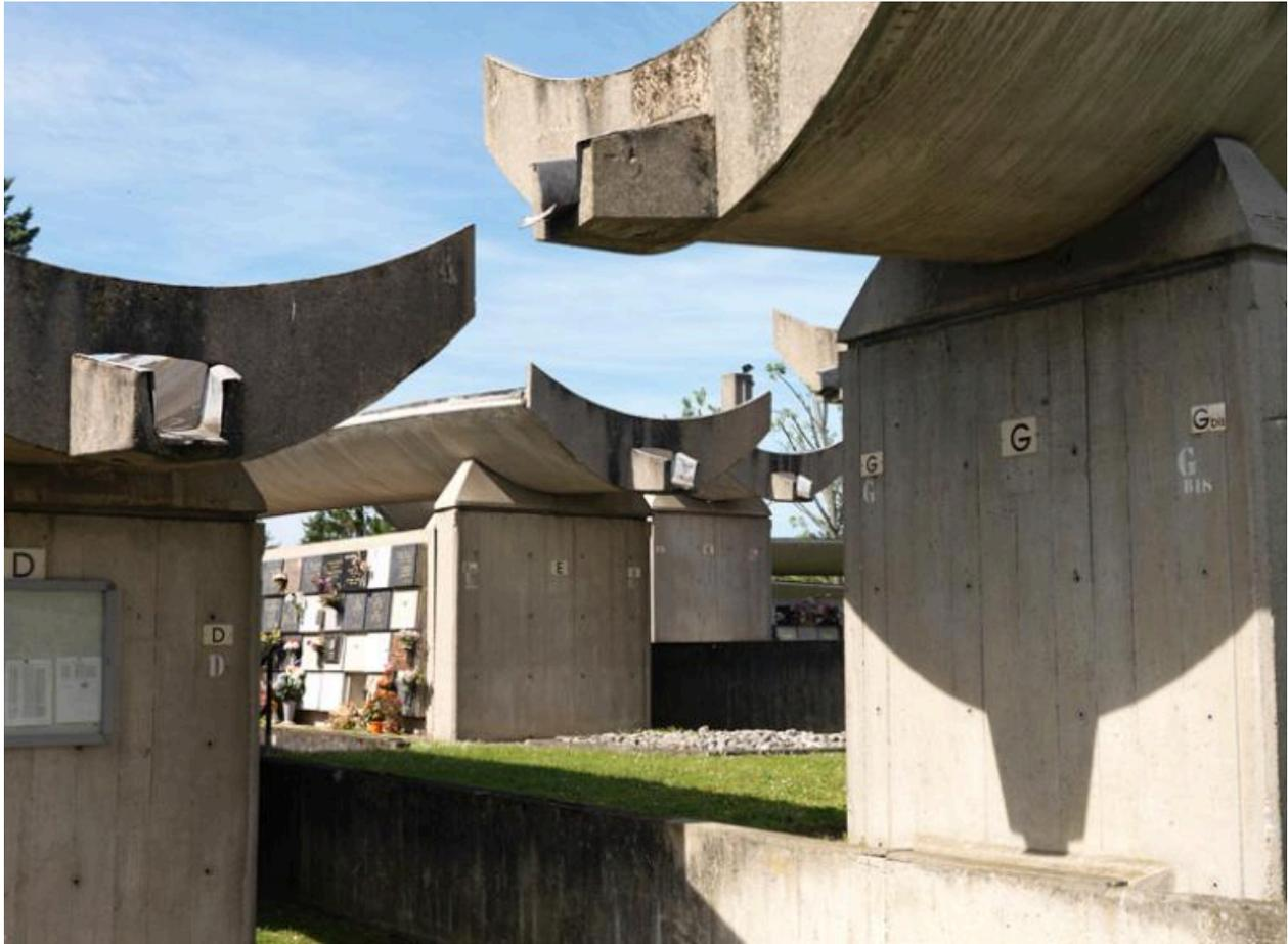
Vue de l'ossuaire, aujourd'hui transformé en columbarium. Auzelle y reprend, à une moindre échelle, le principe de coques monumentales en béton faisant office de chéneaux et de gargouilles.
