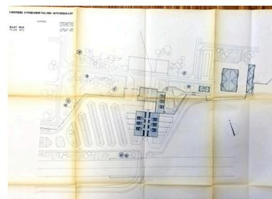
Plan de l'entrée du projet de 1965. On distingue bien le parking, les commerces funéraires alignés en vis-à-vis de part et d'autre de la limite communale. Au-delà, toujours dans l'axe de cette limite l'aire de cérémonie et sur sa droite le bâtiment administratif. A l'extrême est, les ateliers et les garages. SIAF/CAPA. Fonds Robert Auzelle
