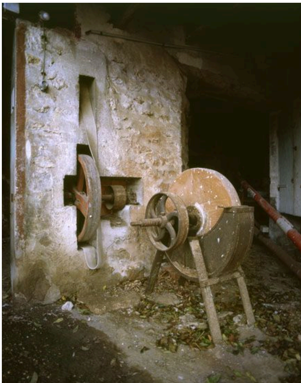
Meule et courroies de transmission pour l'actionner.
