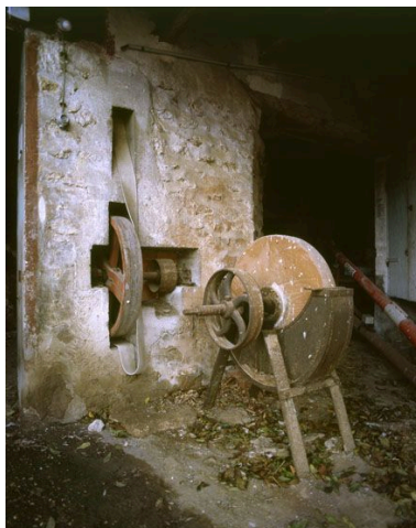
Meule et courroies de transmission pour l'actionner. Phot. Laurent Kruszyk IVR11_20077800548XA
