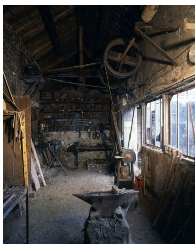
L'ancienne forge : le système de courroie qui actionnait les machines de l'atelier est encore en place. Phot. Laurent Kruszyk IVR11_20077800556XA
