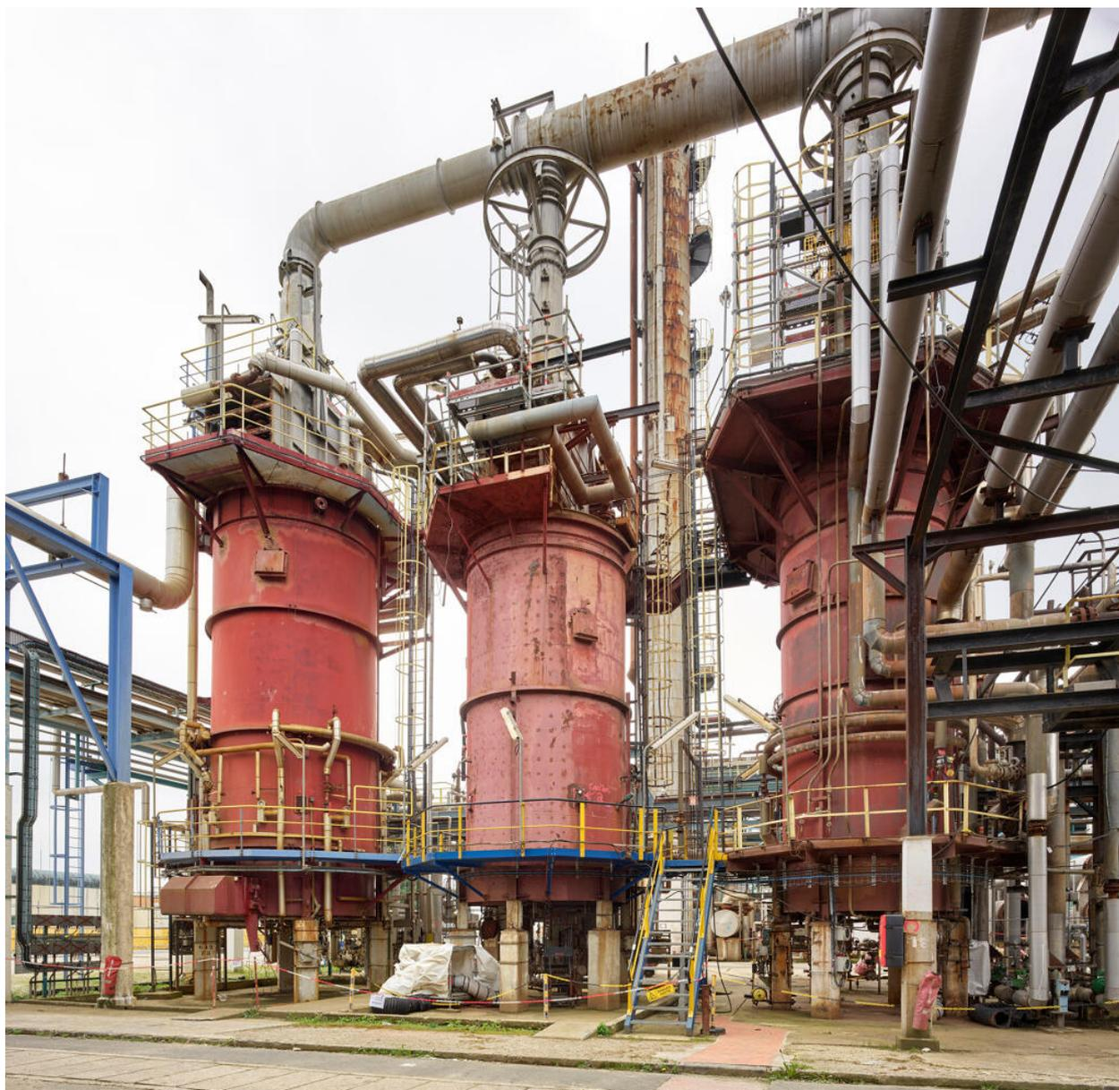
Unités Ouest - Unités 642 (reforming catalytique et HDT2) et 660 (hydrodésulfuration 1). À gauche, le four 642 F5 qui servait à chauffer le fond de la colonne 642 C5, dont la fonction était de retirer le benzène de l'essence. Au centre, le four de l'unité HDT2, le 642 F401. À droite, le four de l'unité HDS1, le 660 F1.
