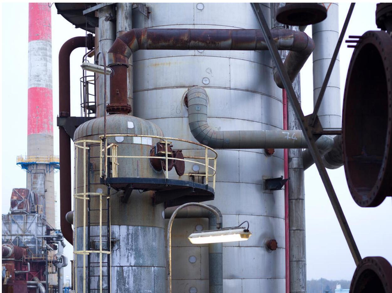
Unités Ouest - Zone de distillation (Unité 612). Colonne 612 C1 avec ses tuyaux de sous-tirage d'un gasoil. Le sous-tirage part de la colonne 612 C1 vers la colonne 612 C2. Dans le fond de la colonne 612 C2, est injectée de la vapeur qui vient rencontrer le gasoil pour permettre de récupérer des microgouttelettes de gasoil plus " léger " qui remontent et refont le chemin entier.
