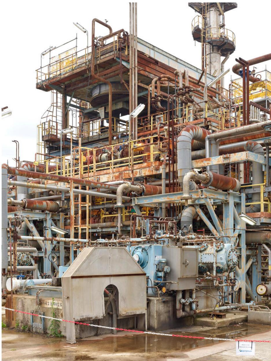
Unités Ouest. Au premier plan, le compresseur d'hydrogène de recyclage de l'unité HDT2, le 642 KM 402 A. En arrière plan, les aéroréfrigérants EM 3002 de l'unité 662 et la colonne 662 C3001 de lavage aux amines haute pression. Les parties démontables du compresseur ont été retirées pour une mise en conservation, dans le but d'être réutilisées pour le projet Biojet.
