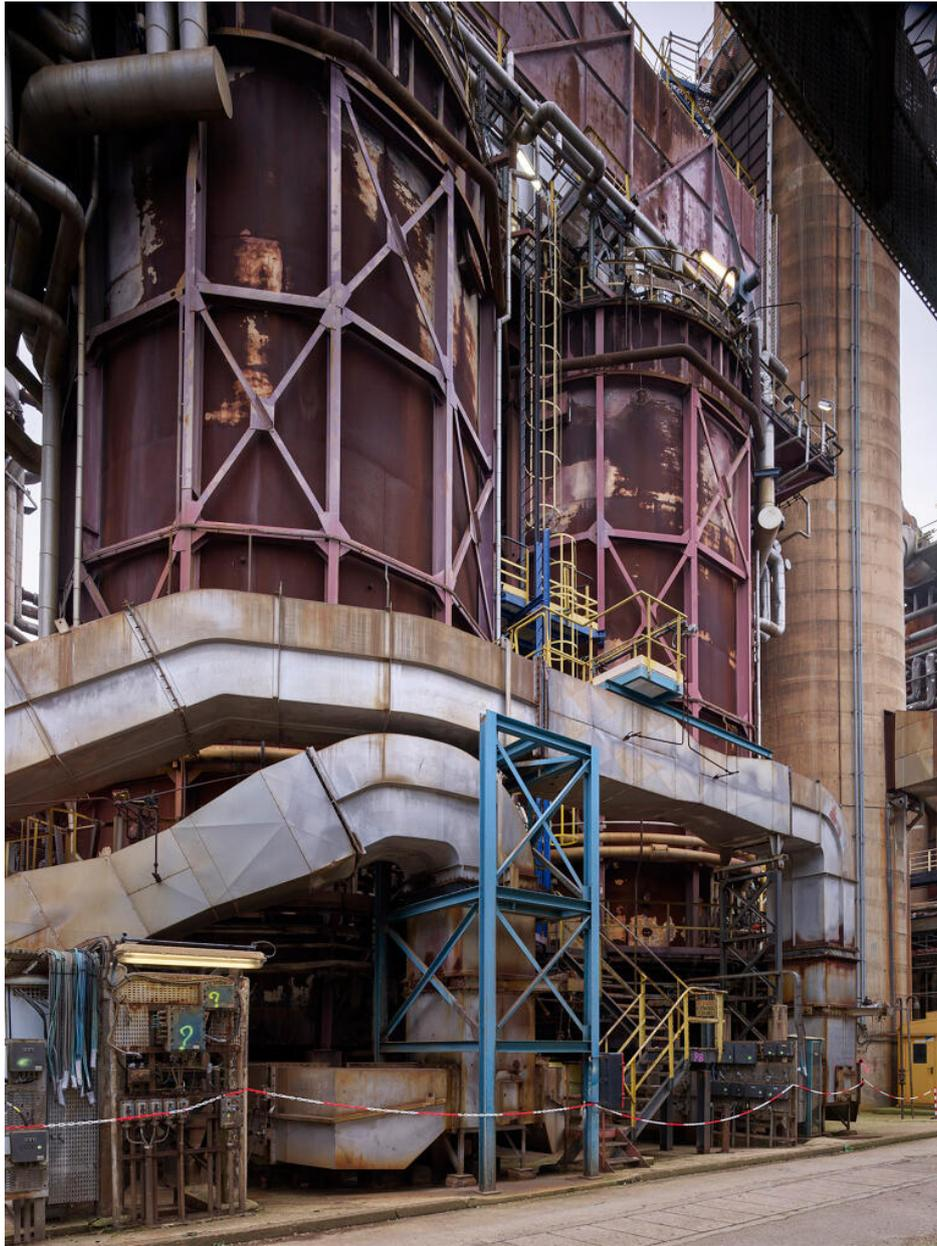
Unités Ouest - Zone de distillation (Unité 612). Fours 612 F1 A et B. Les deux gaines horizontales au premier plan sont destinées à l'alimentation en air des fours, fourni par un compresseur haut débit - basse pression.
