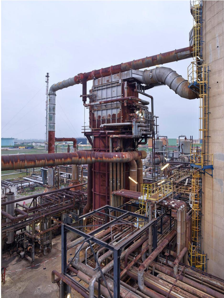
Unités Ouest - Zone de distillation (Unité 612). Four 612 F2, surmonté d'un surchauffeur destiné à élever la température de la vapeur pour ensuite l'injecter dans le procédé (afin de faciliter la distillation).
