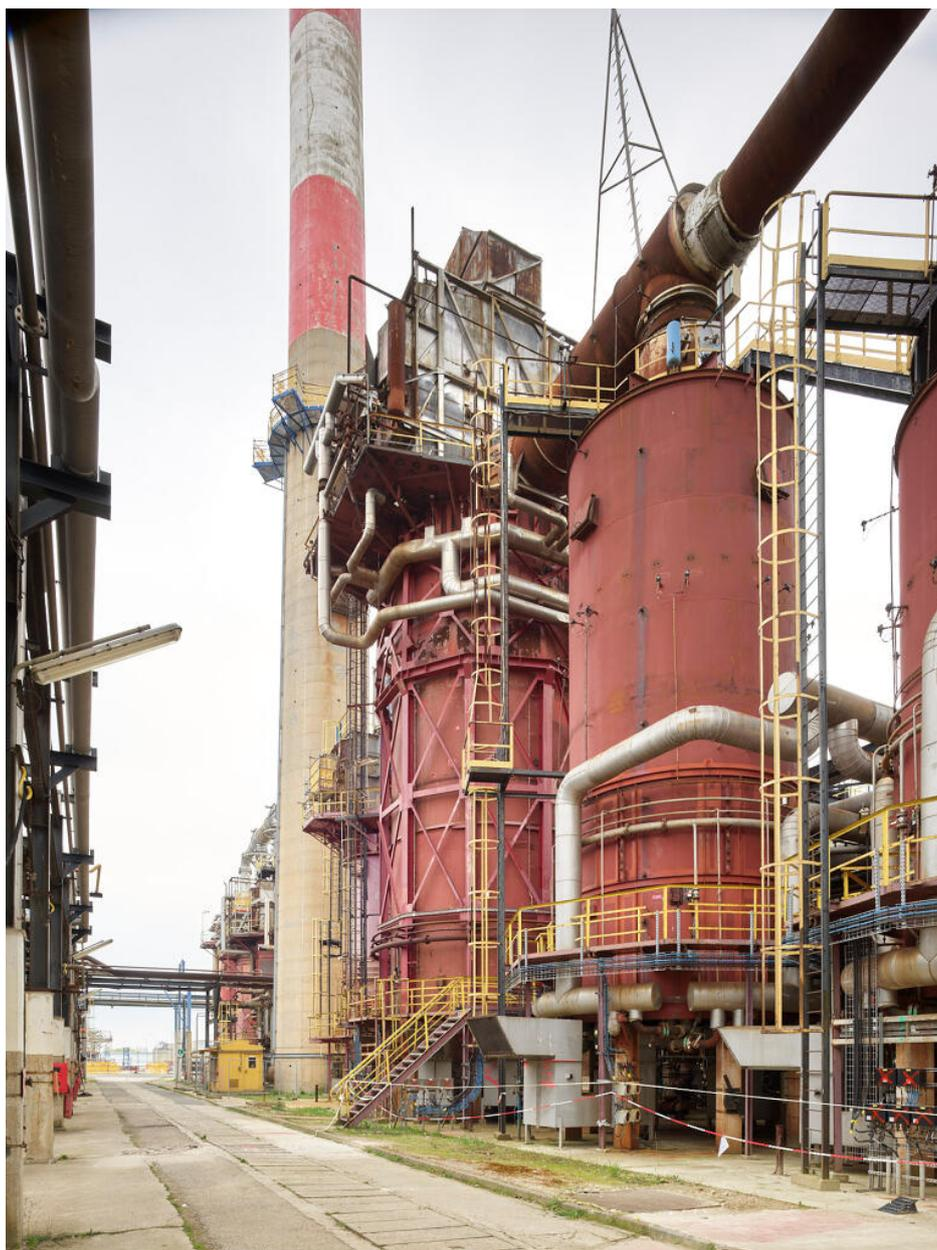
Unités Ouest - Unité 642. Vue sur l'allée des fours des unités catalytiques. Au centre, le plus gros four de l'unité 642 F1 avec son surchauffeur. À sa droite, le deuxième four de l'unité, le 642 F2 et encore à droite (vue partielle) le troisième four, le 642 F3. Ces fours servaient à chauffer l'essence avant son entrée dans les réacteurs (un four par réacteur).
