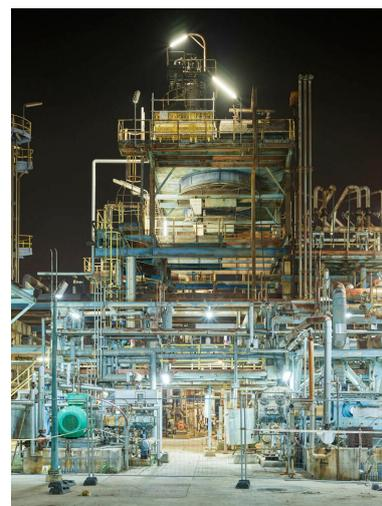
Au c#ur des Unités Ouest, face à une partie de l'Unité 662. Aéroréfrigérants 662 EM 30002, dont le principe est de refroidir les produits avant de les renvoyer dans le système, par circulation d'air.
