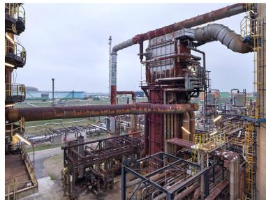
Unités Ouest - Zone de distillation (Unité 612). Four 612 F2, surmonté d'un surchauffeur destiné à élever la température de la vapeur pour ensuite l'injecter dans le procédé (afin de faciliter la distillation). Au centre, la ligne de transfert de résidu atmosphérique (goudron liquide), depuis le four 612 F2 (à droite) vers la colonne 612 C7 (sous vide), qui permettra d'extraire de nouveaux produits à partir de ce résidu.
