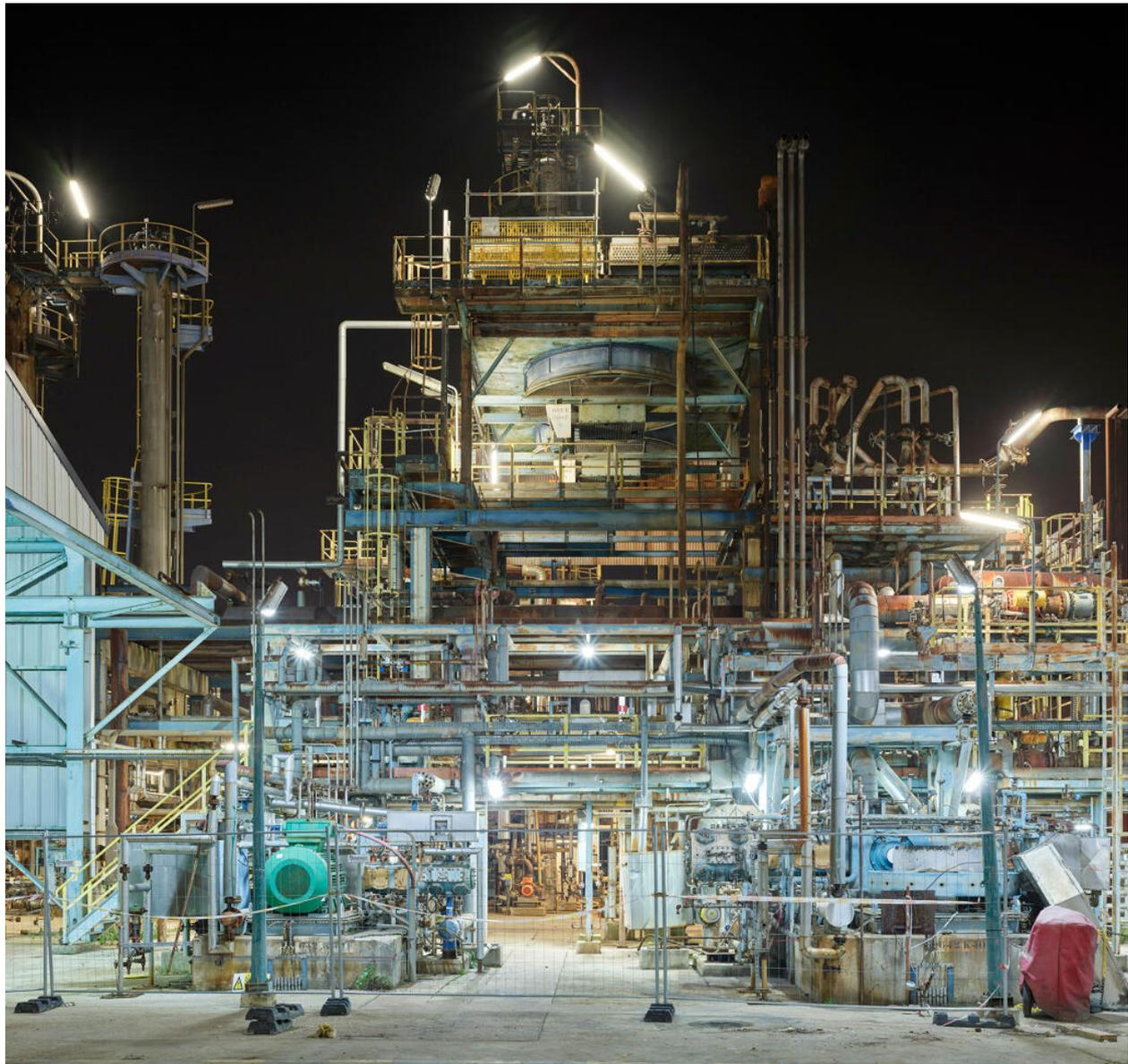
Au cœur des Unités Ouest, face à une partie de l'Unité 662. Aéroréfrigérants 662 EM 30002, dont le principe est de refroidir les produits avant de les renvoyer dans le système, par circulation d'air.
