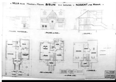
Plans du sous-sol, rez-de-chaussée et comble; coupe; élévations antérieure et postérieure. Calque, 1934. (AD Val-de-Marne. 27 J 163) IVR11\_19869400739X
