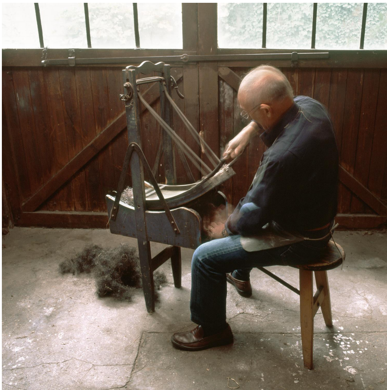
M. Gilbert Eberlin, qui a fait son apprentissage dans l'atelier de tapisserie, restitue quelques gestes du travail. La cardeuse à main ou balancelle permet d'ouvrir le crin, destiné par exemple à uniformiser le fond d'un fauteuil.
