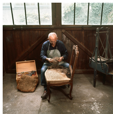
M. Gilbert Eberlin, qui a fait son apprentissage dans l'atelier de tapisserie, restitue quelques gestes du travail. Après le garnissage du siège, la mise en crin (précédant la piqure crin) permet d'uniformiser le fond et d'éliminer les bosses
