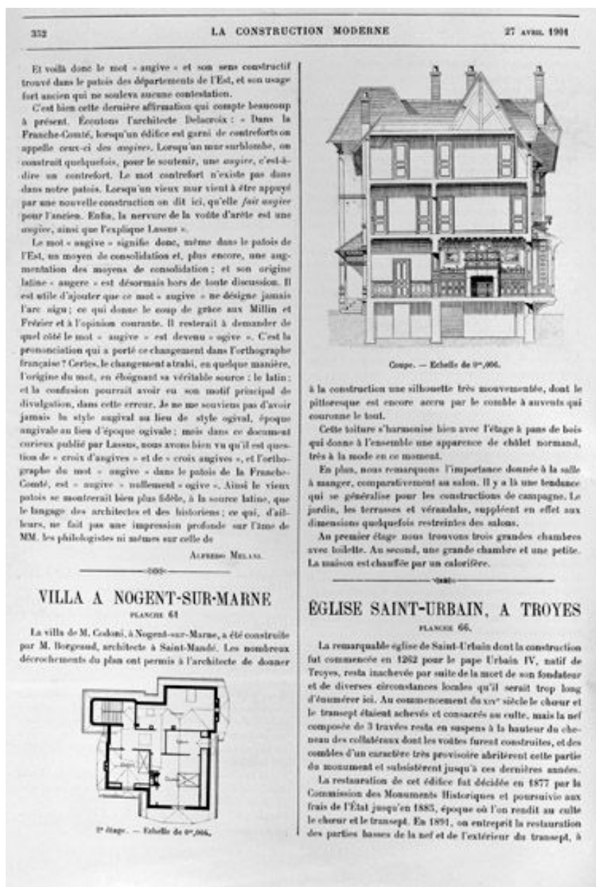
Plan du second étage et coupe d'une maison. Tiré de : La construction moderne, 1900-1901, t.6.
