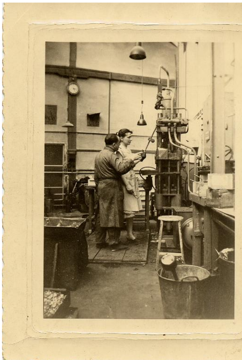
Presse hydraulique Pinette de la fonderie Zamac, vers 1950. Photographie. (Musée de l'histoire vivante, Montreuil)
