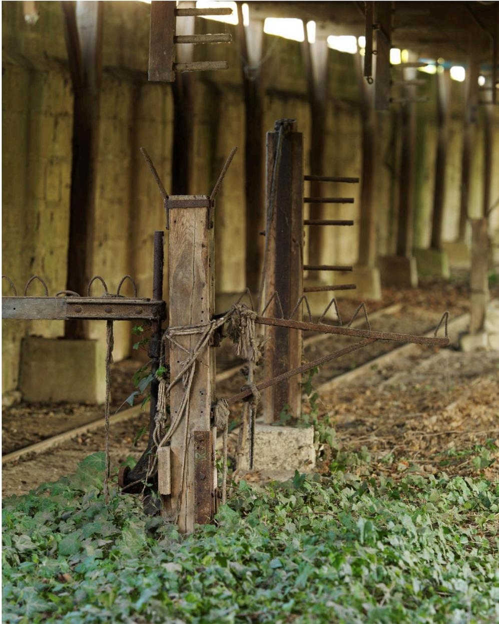
Installations pour le câblage des cordes, support ou guide, puis séparateurs de torons et au-dessus, les râteliers.
