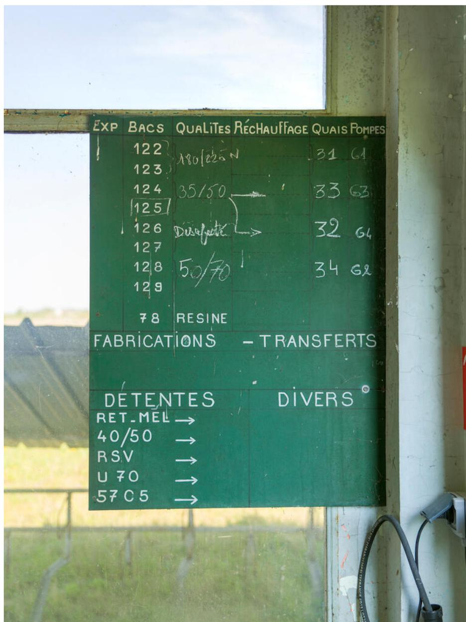
Zone bitume (Unité 570). Ancienne salle de contrôle bitume, tableau des caractéristiques des différents bitumes, et affectation des quais de chargement (avant automatiser).
