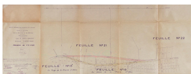
Plan montrant la déviation du C.D. 29 dans le quartier du Val d'Athis pour élargir l'emprise des voies ferrées : plan d'ensemble au 1/5000è, 4 juillet 1949. IVR11_20039100059XA
