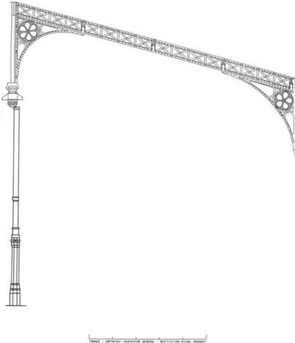
Elévation d'une ferme transversale. Restitution photogrammétrique, 1983.
