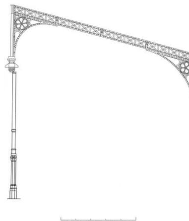
Elévation d'une ferme transversale.
