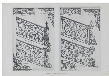
Modèles de panneaux rampants et de départs en ferronnerie de style rocaille (non localisé). Gravure, 18e siècle. Tiré de : Le fer forgé en France, la Régence : aurore, apogée, déclin, oeuvres gravées des anciens maîtres serruriers, architectes, dessinateurs et graveurs / Louis Blanc. Paris : G. Van Oest, 1930.
