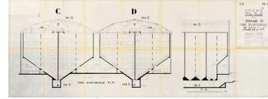
Silos de l'UNCAC de la Grande Paroisse. Stockage S1. Coupe transversale sur halls C et D.
