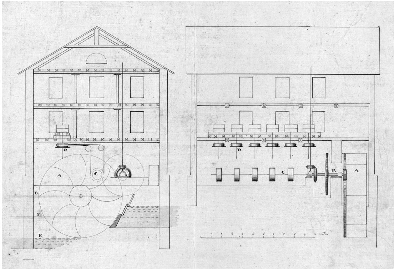
Coupes transversale et longitudinale montrant les mécanismes de transmission de l'énergie, s.d. [en note : projet 8 juil. 1854].
