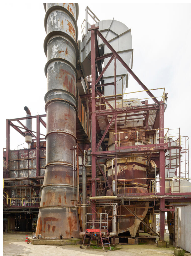
Unités Est - Zone du viscoréducteur (Unité 691). Vue sur les lignes des fumées du four du viscoréducteur. Phot. Stéphane Asseline, Phot. Stéphane Asseline IVR11_20237700283NUC4A
