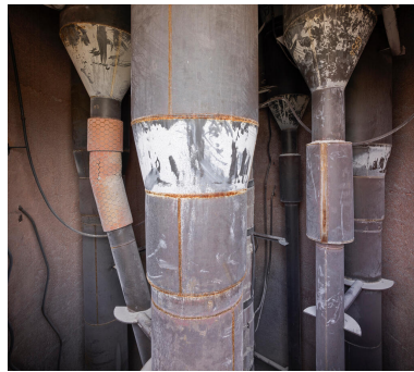
Unités Est - Zone FCC (Unité 651). Jambes de circulation du catalyseur à l'intérieur de la zone réactionnelle. Phot. Stéphane Asseline, Phot. Stéphane Asseline IVR11_20237700281NUC4A
