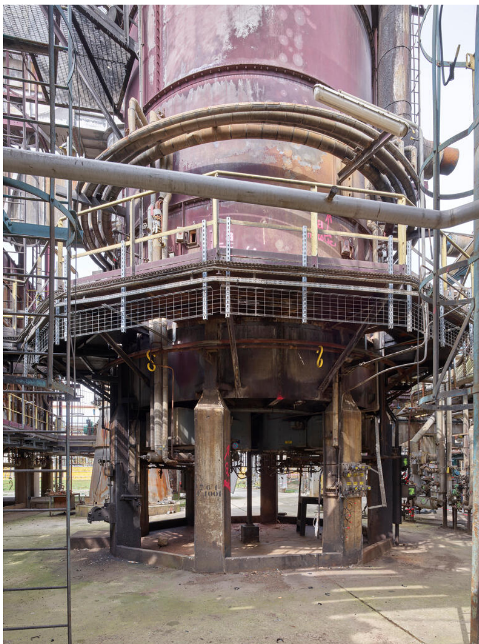
Unités Est - Zone du viscoréducteur (Unité 691). Gros plan du four de l'alkylation.
