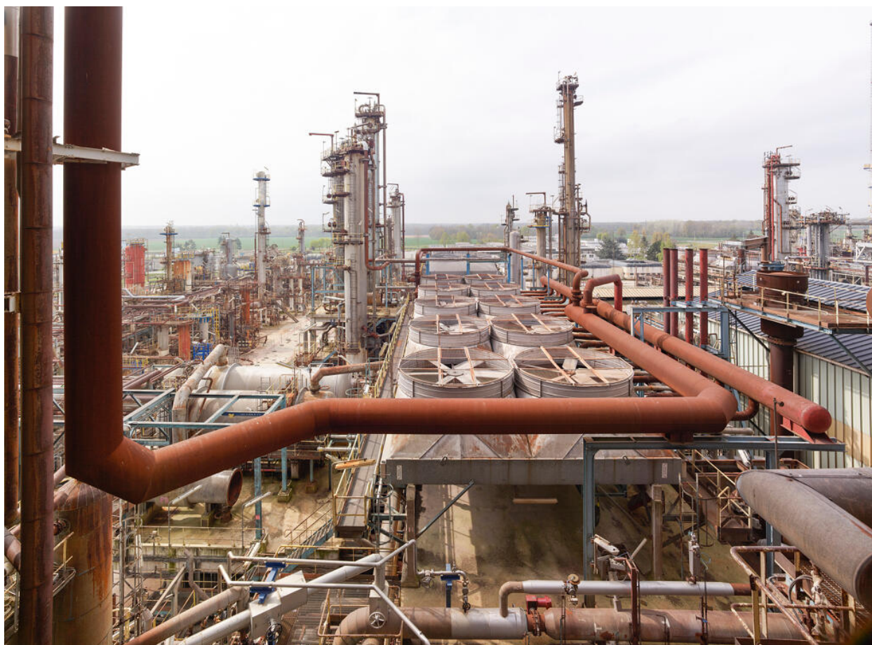
Unités Est - Zone FCC (Unité 651). Vue sur la partie supérieure des aëroréfrigérants E 1001 depuis la zone réactionnelle du FCC.
