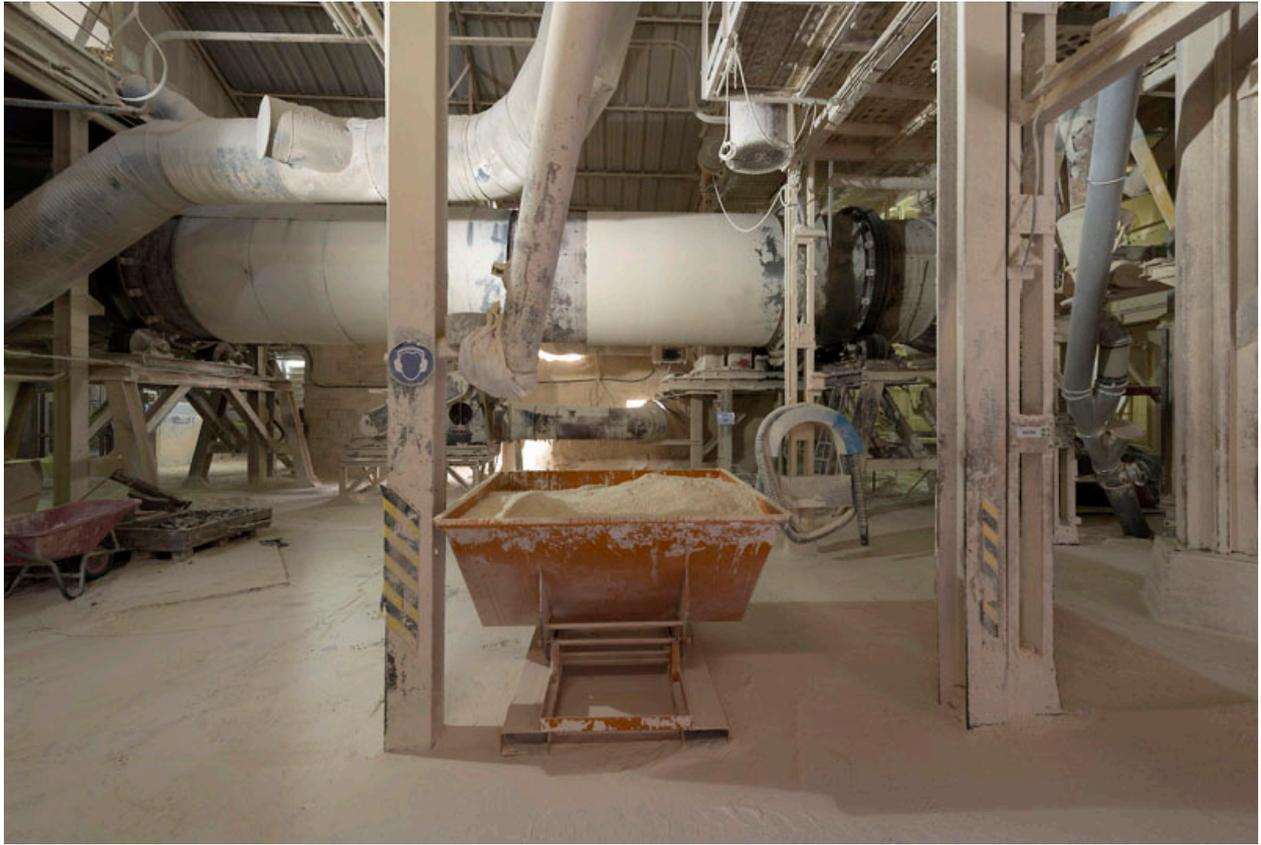
Usine de filler BR1. Séchage au gaz dans un cylindre rotatif VERNON (14x10m) avec filtre à manches.
