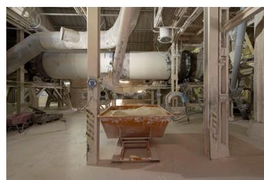
Usine de filler BR1. Séchage au gaz dans un cylindre rotatif VERNON (14x10m) avec filtre a manches.
