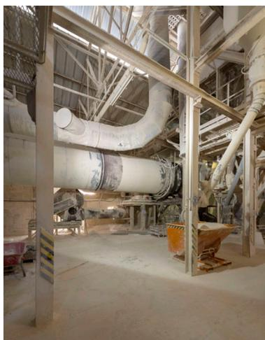
Usine de filler BR1. Séchage au gaz dans un cylindre rotatif VERNON (14x10m) avec filtre à manches.
