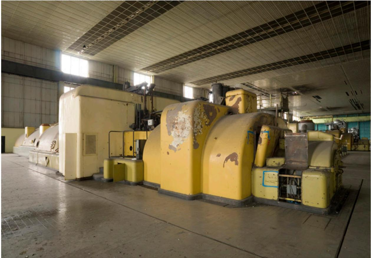
Poste d'eau tranche 125 MW. Turbine de construction Alsthom.
