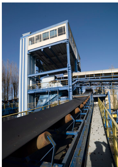
Parc a charbon. Manutention. Tapis-jeteur. Phot. Philippe Ayrault IVR11_20087700467NUC4A
