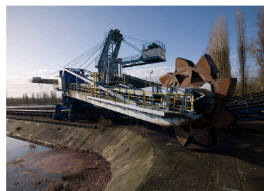
Parc à charbon. Manutention. Roue-pelle. Phot. Philippe Ayrault IVR11_20087700463NUC4A
