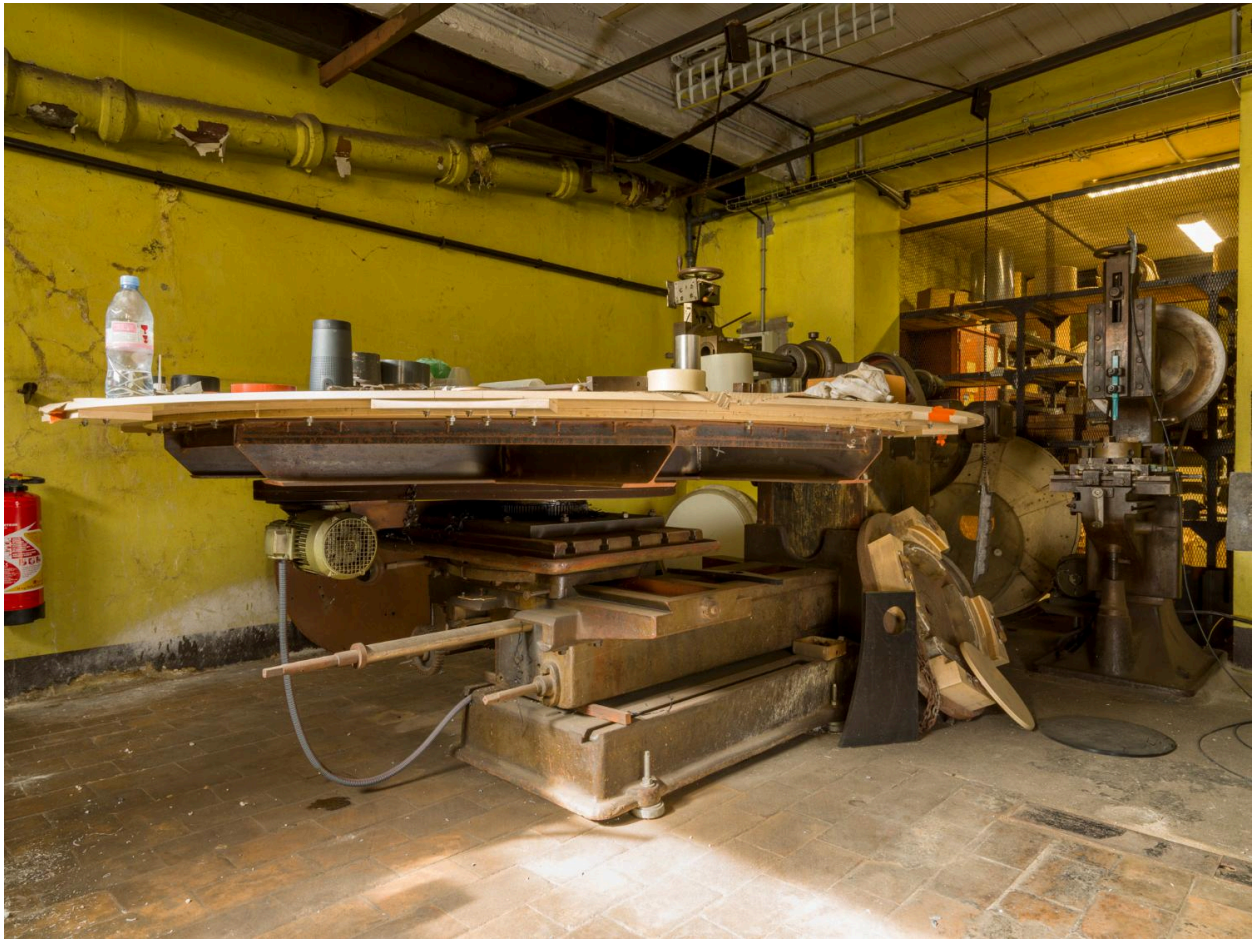
Atelier de mécanique générale (usinage). Transformation d'une ancienne aléuseuse en tour vertical pour usinage de pièces en matières plastiques de diamètre inférieur à 2,6 m.
