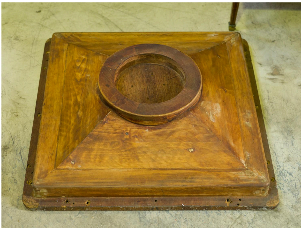
Atelier de thermoformage. Moule de fabrication.
