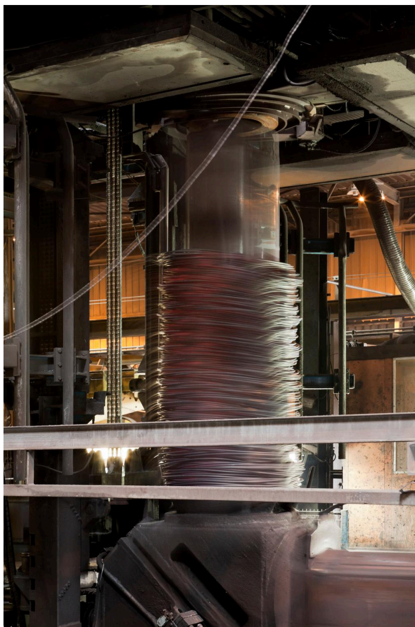
Halle des laminoirs, formation des bobines de spires. (réf. Département Seine-et-Marne : IVD77_2013_77_00255_NUCA)
