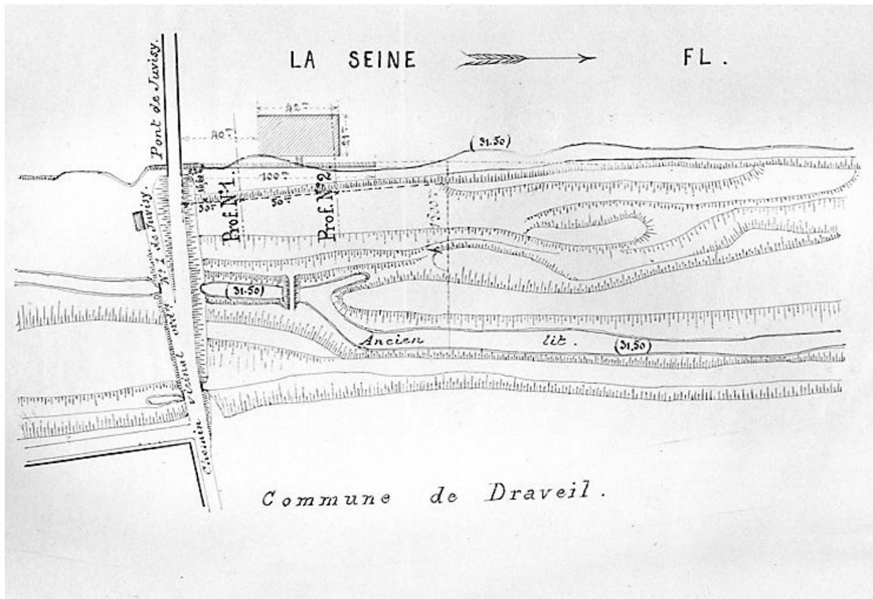
Projet d'installation en Seine d'un établissement de bains-douches, d'un lavoir et d'un bassin de natation : plan de situation marquant la profondeur du lit du fleuve, document dessiné entre 1893 et 1899. (AD Essonne, 3 S 26)
