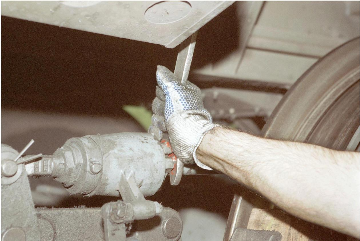
Vérification du système de freinage. Lorsque l'agent décèle un "dur mécanique", le SAB doit être huilé.
