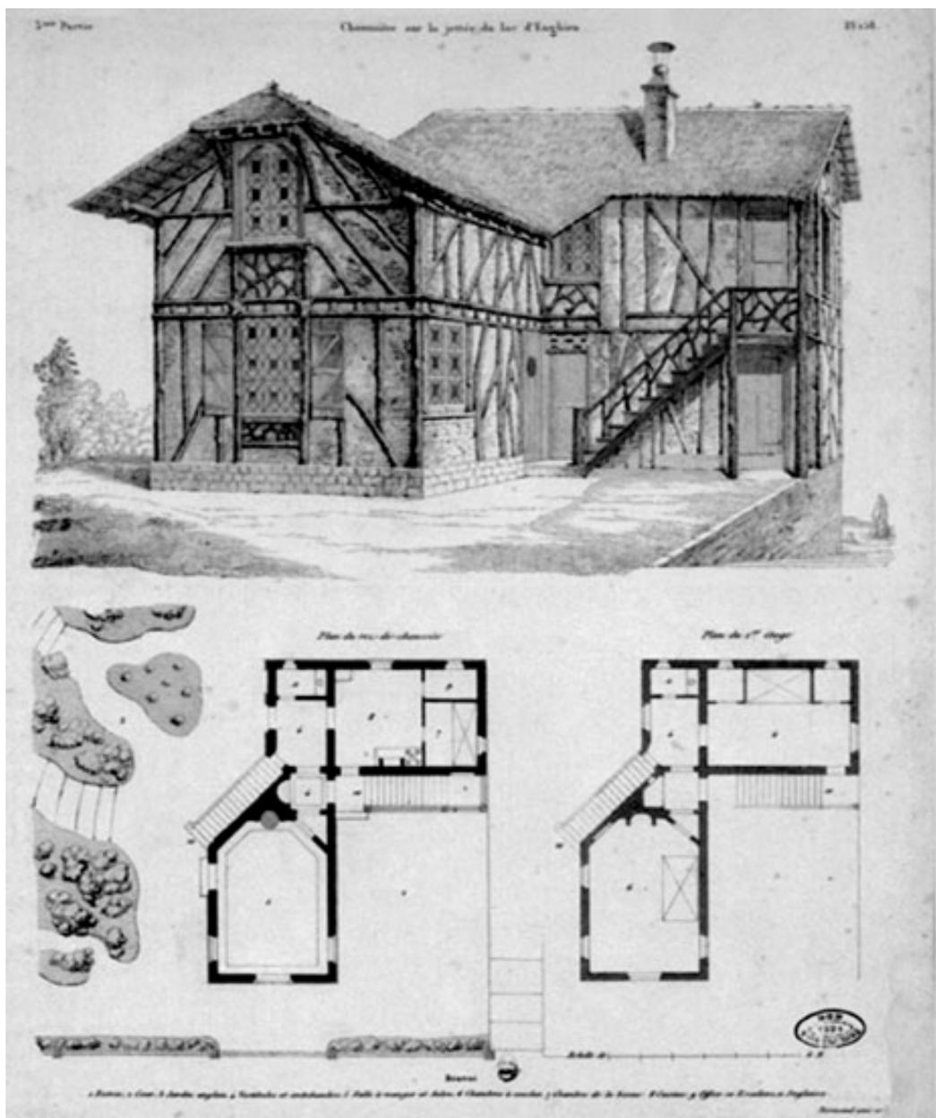
Chaumière sur la jetée du lac d'Enghien : plans du rez-de-chaussée et du premier étage, élévation. Gravure. (BNF, Département des estampes, Topo Va, Fol. Tome III, Val d'Oise, B16364)
