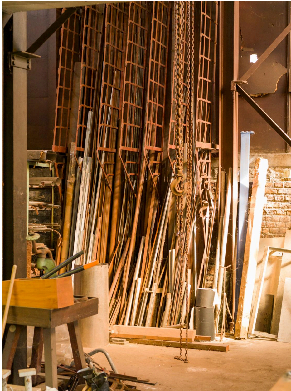
Chaudronnerie métallique. Casier de rangement de profilés aciers.
