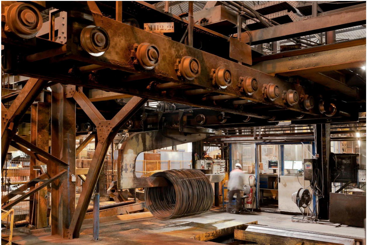
Halle des laminoirs, formation des bobines de spires. (réf. Département Seine-et-Marne : IVD77_2013_77_00256_NUCA)
