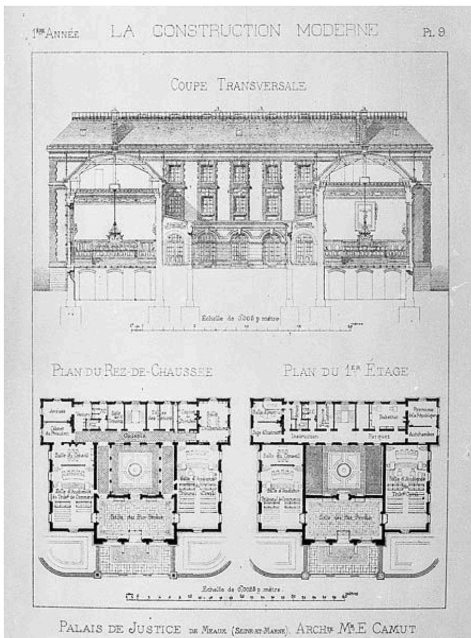
Coupe transversale, plan du rez-de-chaussée, plan du premier étage. Gravure. Tiré de : "La Construction moderne", 1885, pl. 9. (BNF. Département des estampes, TopoVa Seine-et-Marne)
