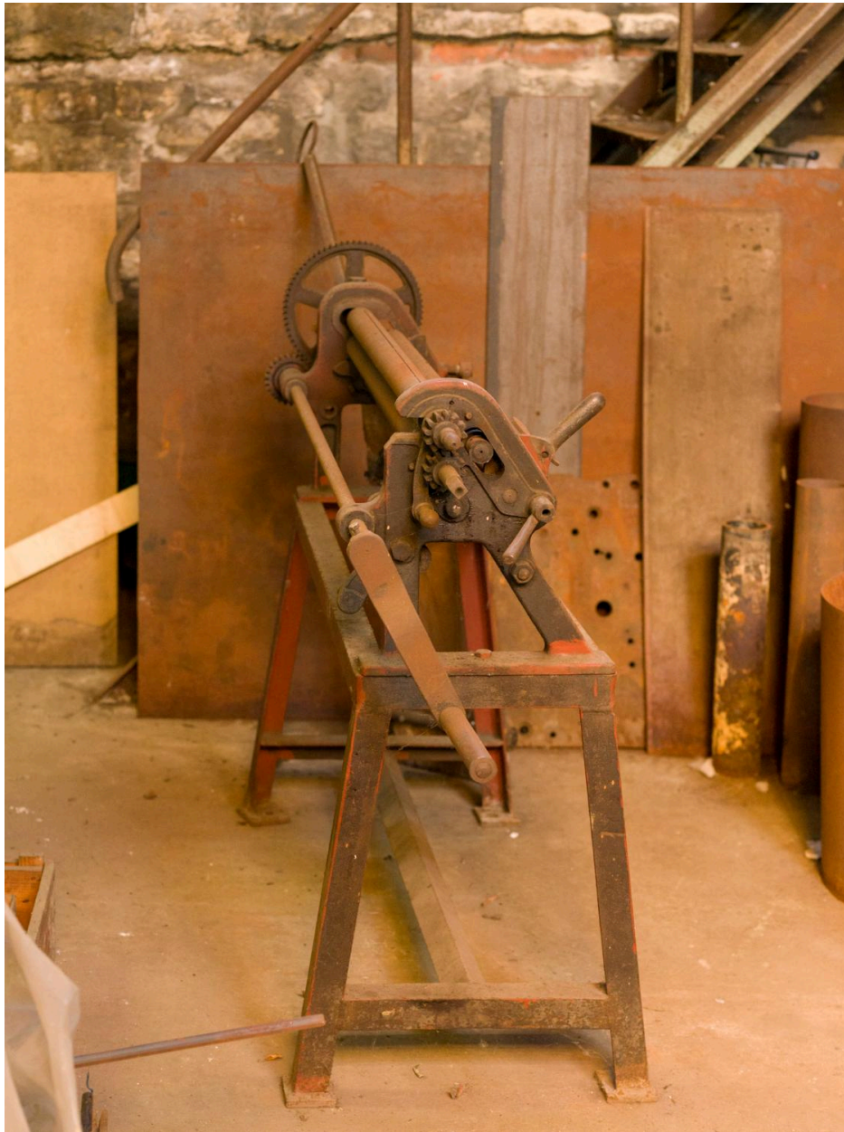
Chaudronnerie métallique. Rouleuse.
