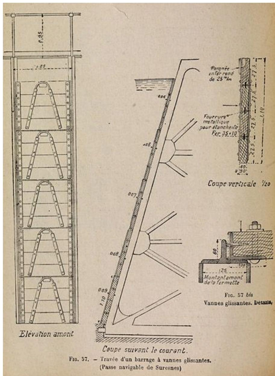
Travée d'un barrage à vannes glissantes. Elévation, coupe. Tiré de : Notions de navigation intérieure / M. Fourrey. Paris : Ecole spéciale des travaux publics, 1929.
