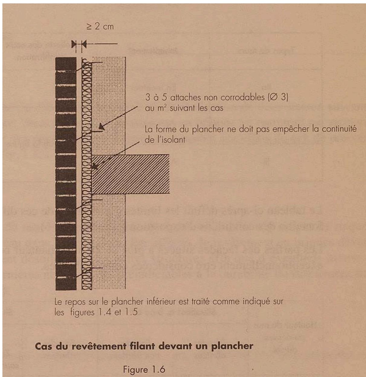
Maçonnerie de brique pleine doublée d'une paroi de béton avec isolant intermédiaire. Tiré de : Centre technique des tuiles et briques, *Tuiles et briques de terre cuite* / Paris : Le Moniteur, 1998, collection Memento technique.
