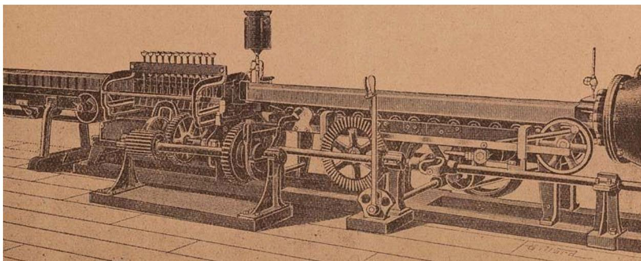
Vue d'ensemble d'une machine à découper automatiquement la pâte servant à fabriquer la brique. Tiré de : La céramique industrielle, chimie, technologie / Albert Granger. Paris, Gauthier-Villars, 1929, p. 423, fig. 180.
