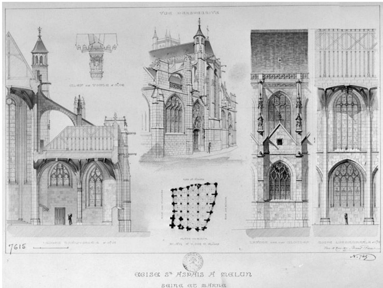
Coupe transversale, vue perspective, plan, travée rue des Cloches, coupe longitudinale.
