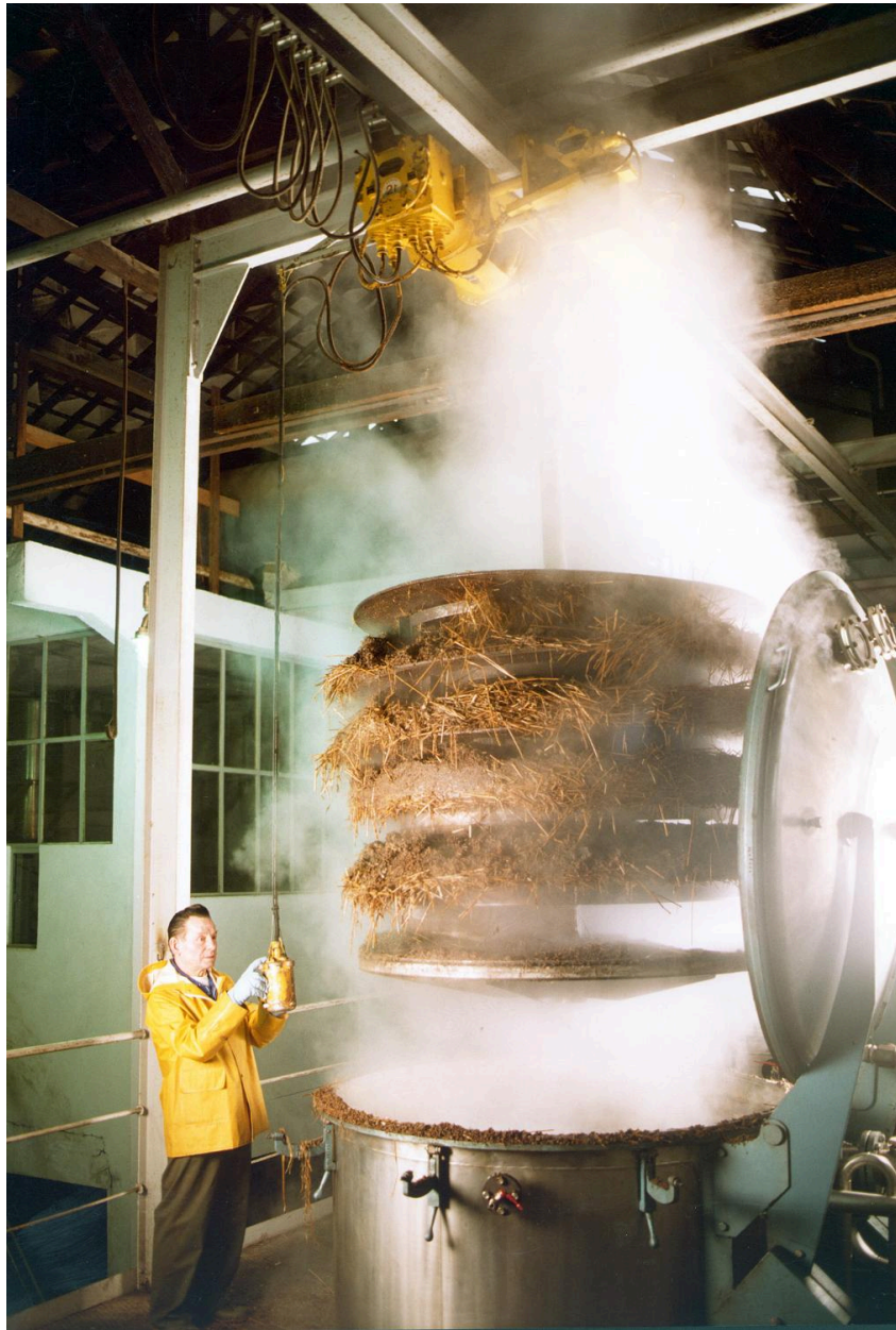
Bâtiment B, grand laboratoire. Extracteur de 3000 litres, les plantes épuisées sont retirées de la cuve après infusion. Vers 1998.
