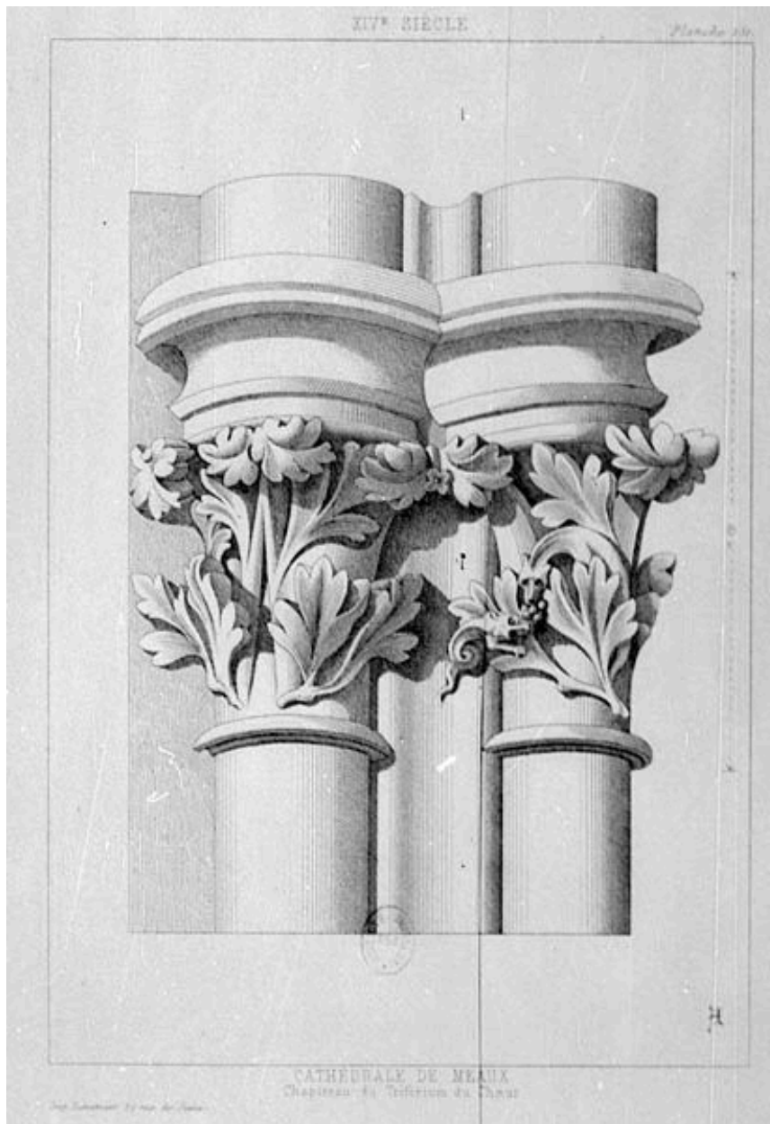
La cathédrale au 19e siècle : détail d'un chapiteau géminé du triforium du chœur. Gravure. (BNF. Département des estampes, TopoVa Seine-et-Marne, H 156264)
