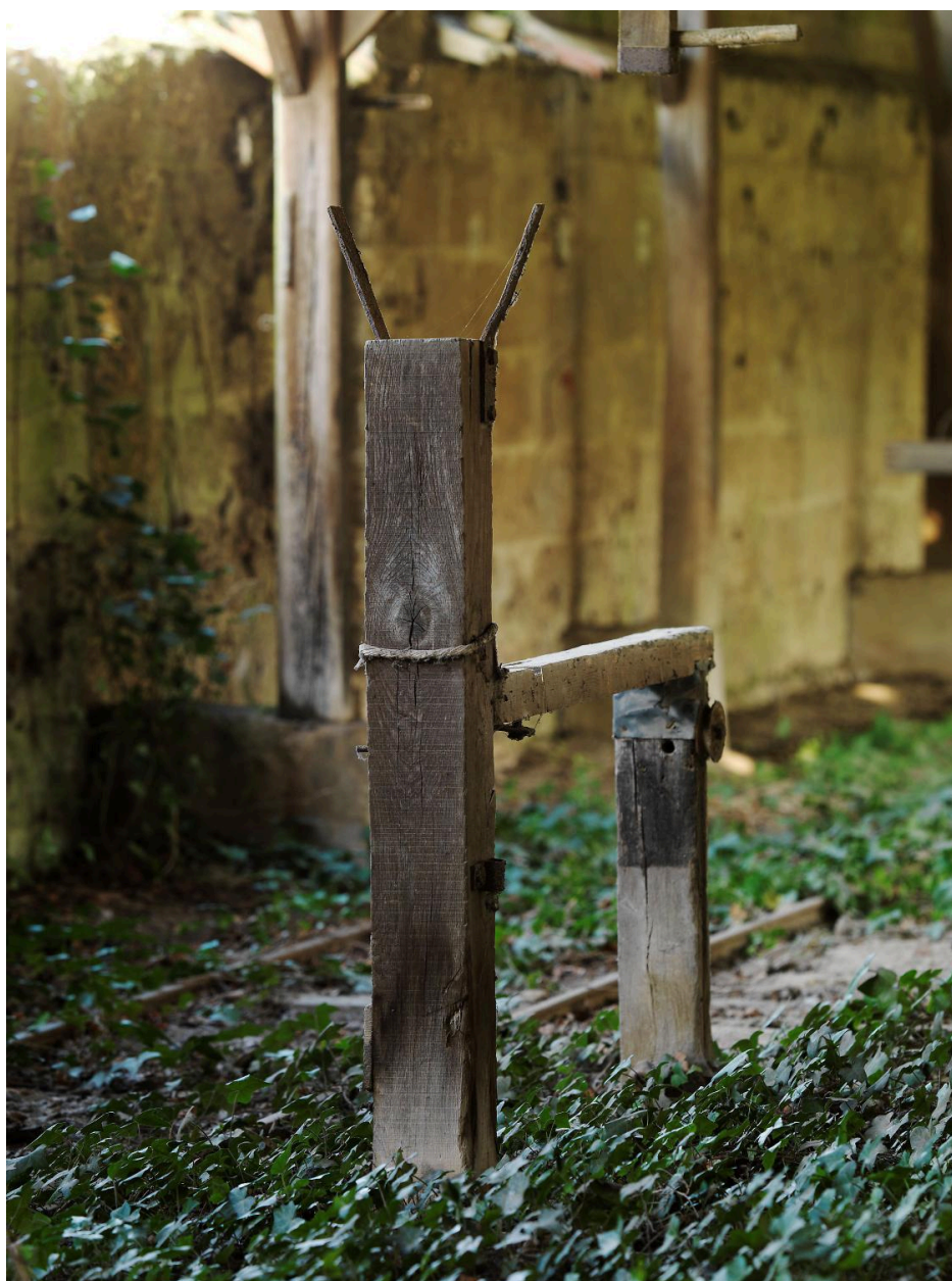
Installations pour le câblage des cordes, support ou guide.
