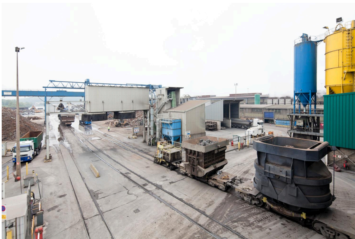
Parc à ferrailles avec un wagonnet chargé en ferrailles destiné à l'alimentation du four. (réf. Département Seine-et-Marne : IVD77_2013_77_00236_NUCA)
