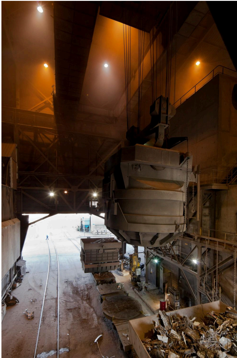
Halle du four, transbordement du panier vers le four. (réf. Département Seine-et-Marne : IVD77_2013_77_00272_NUCA)
