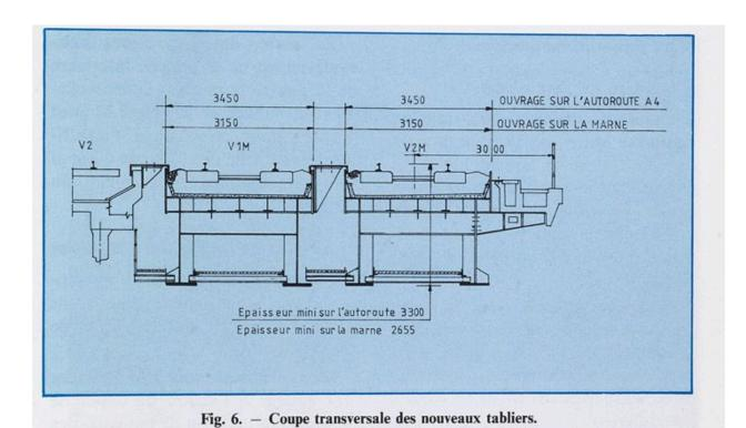
Pont ferroviaire de la ligne Paris-Lyon. Coupe transversale des nouveaux tabliers. Tiré de : Travaux sur le pont de Charenton, remplacement des tabliers en fonte des ponts-rails sur l'autoroute A4 et sur la Marne sous les voies de la ligne Paris-Marseille / F. Jouvie, C. Vicherat. In Revue Générale des Chemins de Fer, juin 1987, p. 21.
